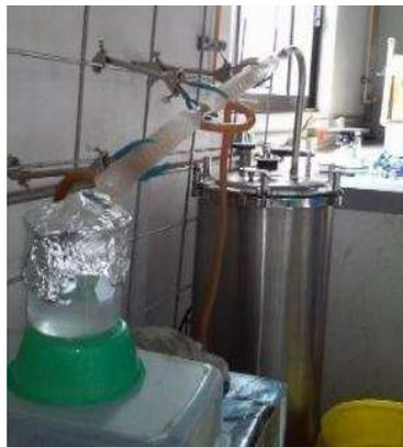
**Figura.4 A.** Extracción del aceite esencial de *T. lucida* por arrastre de vapor.
