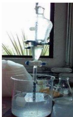
**Figura.4 B.** Separación de AE fase acuosa de fase orgánica en embudo de separación
