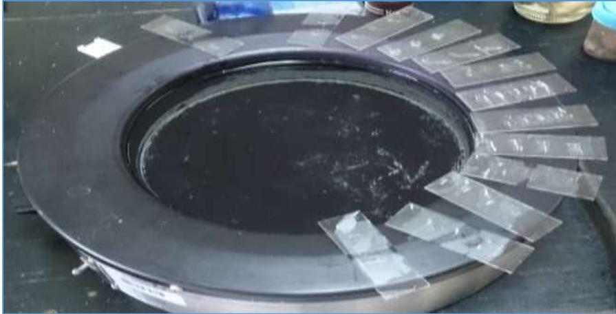
**Fig. 33** Montaje en laminillas de los cortes.
