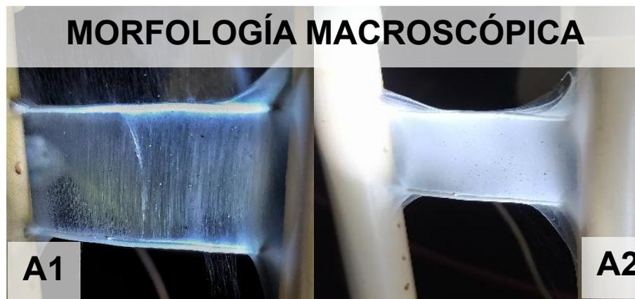
**Figura 7.7.** Colecciones de nanofibras PVA-ETOH-TTC 10:2 a 14 cm, 13.4 kV, 0.3 mL/h y 22°C :
