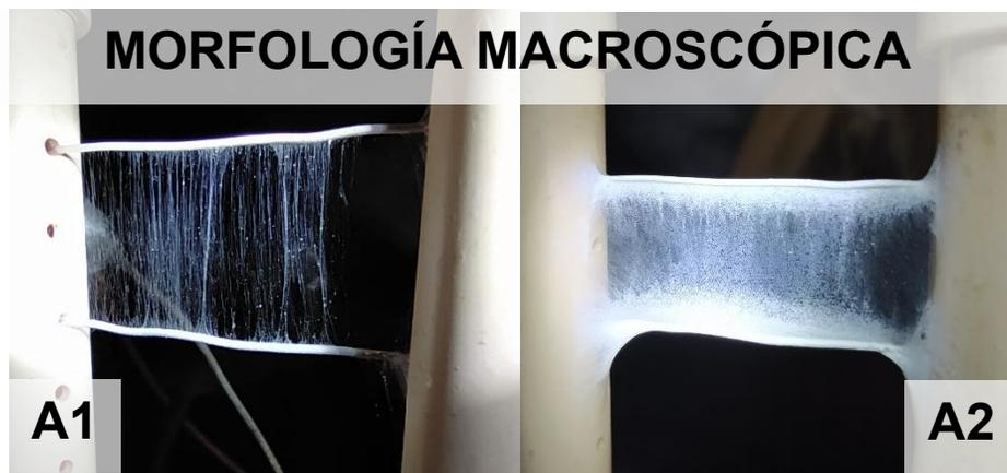
**Figura 7.6.** Colecciones de nanofibras PVA-ETOH-TTC 10:2 a 13 cm, 10.4 kV, 0.3 mL/h y 10 °C :
