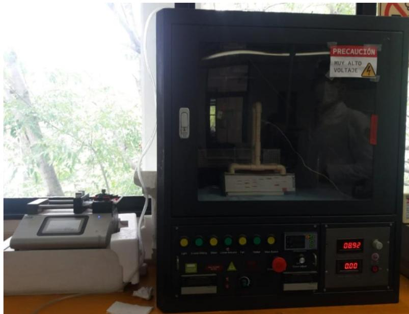
*Fig 6.1. Equipo de electrohilado Naobond Technologies®.*
