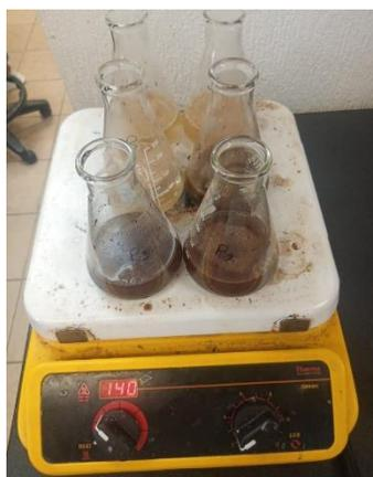
*Ilustración 11. Muestras después del secado (crisol superior semilla de papaya, crisol inferior semilla de sandía).*
