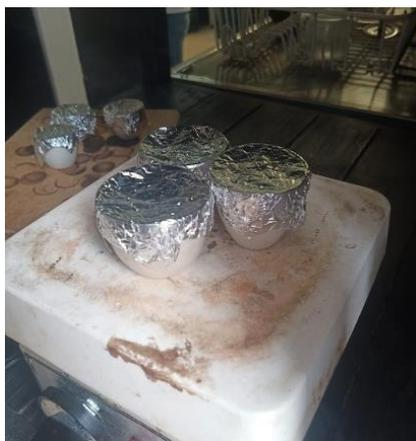
*Ilustración 5. Muestras carbonizadas (crisol superior semilla de sandía, crisol inferior semilla de papaya).*
