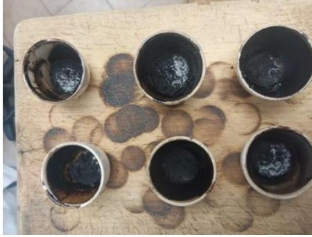
*Ilustración 6. Muestras calcinadas (crisol superior semilla de sandía, crisol inferior semilla de papaya).*
