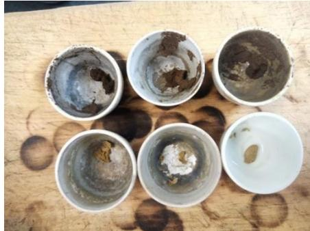
*Ilustración 12. Muestras después de calcinar (crisol superior semilla de papaya, crisol inferior semilla de sandía).*
