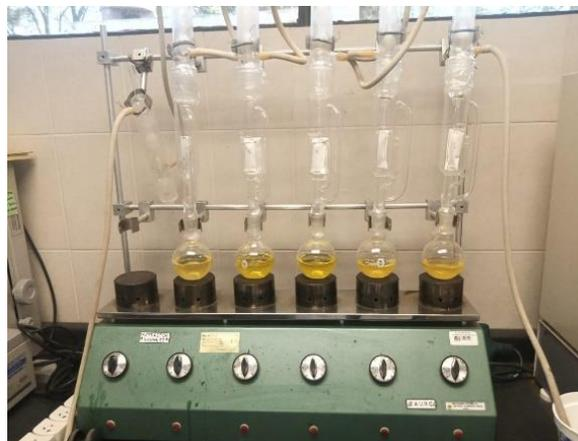
*Ilustración 8. Extracción del éter etílico*
