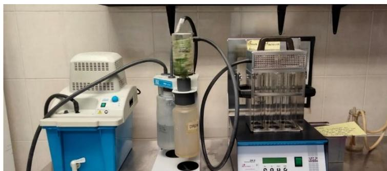
*Equipo de digestor Kjeldahl*
