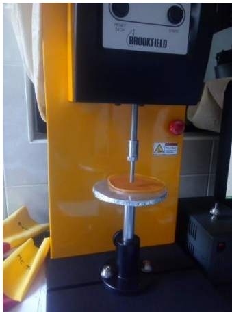
Figura 15: Texturometro brookfield CT3 resistencia fuerza punción
