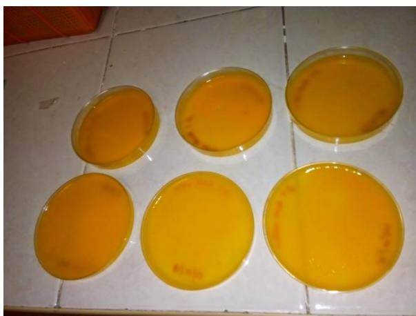
Figura 12: Método casting para elaboración de películas comestibles
