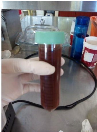
Figura 11: Solución de nanopartículas de plata antes de centrifugar
