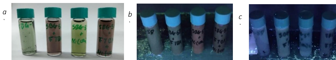
Figura 28. a) Preparado de 8 en MeCN con sol iónicas; b) Preparados expuestos a luz UV de longitud corta; c) Preparados expuestos a luz VU de longitud larga.
