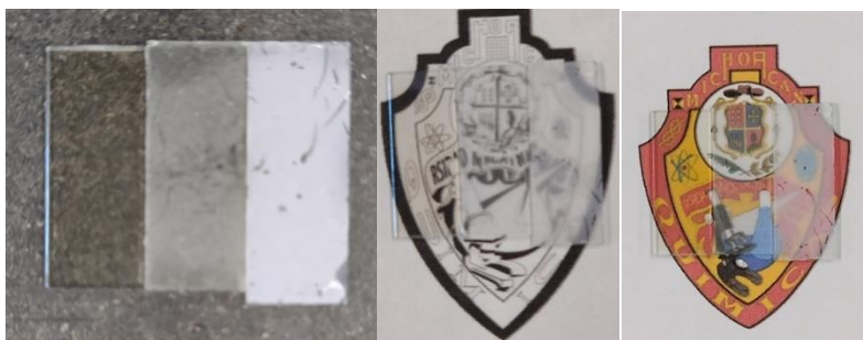
Figura 8. Comparativa de transparencia entre los diferentes ITO's (ITO solo, ITO/NF-PVADMSO y ITO/NF-PVAH 2 O).
