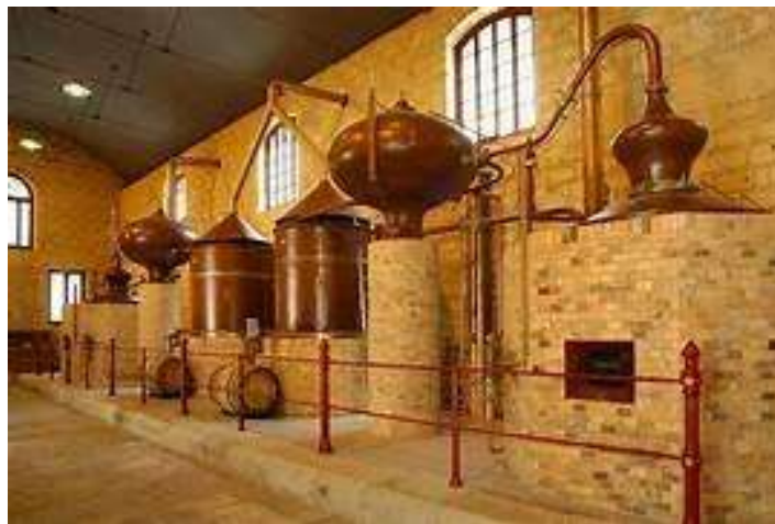
Figura 4. Modelos de alambiques de metal para la destilación de fermentados en México.
