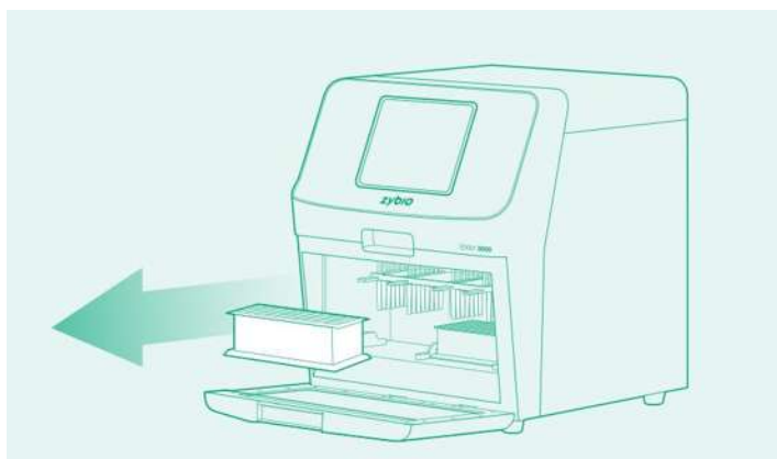
Figura 5. Retiro de la placa del equipo EXM3000 y fin de corrida.
