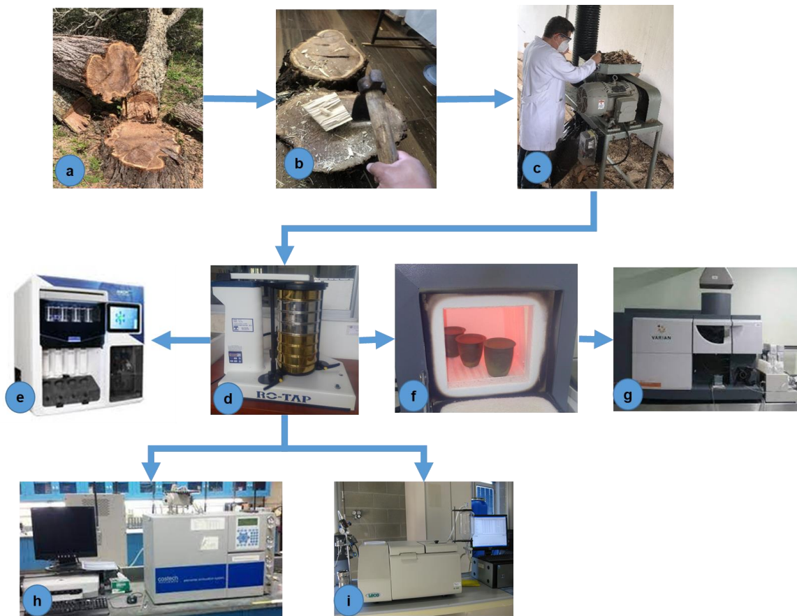
Figura 2. Diagrama general de la metodología, a) derribo del árbol, b) astillado, c) molienda en un equipo convencional, d) tamizado para obtener harina de madera de tamaño de partícula 425 \mu\text{m} , e) análisis de la composición química (celulosa, hemicelulosa, lignina y extraíbles), f) análisis proximales (cenizas, materia volátil y carbono fijo), g) microanálisis de las cenizas, h) análisis elemental (carbono, hidrógeno, oxígeno, nitrógeno y azufre), i) determinación del poder calorífico.
