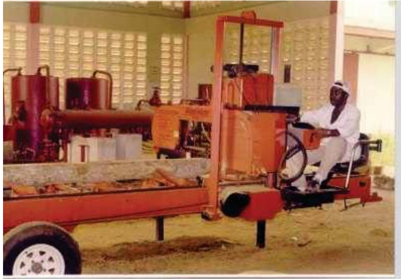
Figura 4. Aserradero móvil horizontal. Fuente: Okay. 2001.
