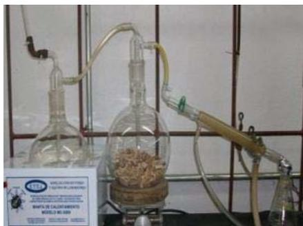
**Figura 13.** Equipo de destilación por arrastre con vapor. Se observa la obtención de los aceites esenciales de la madera de *T.donnell-smithii*.
