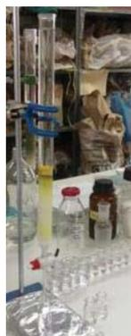
**Figura 20.** Cromatografía en columna del extracto hexánico de la corteza de *T. rosea*. Se observa el corrimiento de la cromatografía y la obtención de las fracciones en cada uno de los viales a la derecha de la imagen.
