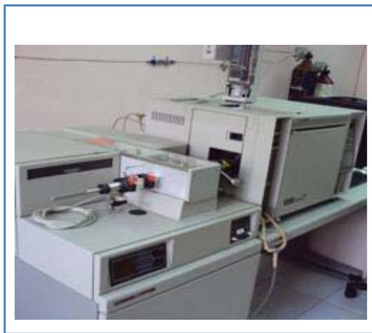
**Figura 22.** Cromatógrafo de Gases acoplado a un Espectrómetro de Masas.
