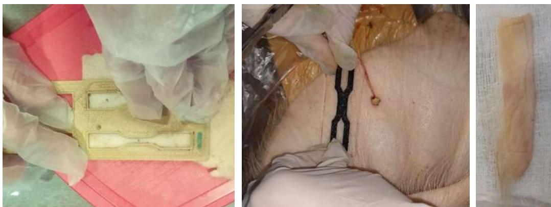
Figura 33. Adquisición de muestras de la piel porcina, con ayuda de un molde hecho en impresora 3D, para ensayos de tensión.
