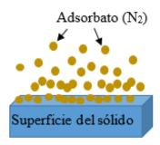
Figura 9. Adsorción física del nitrógeno [83].
