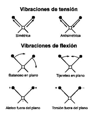
Figura 14. Tipos de vibraciones moleculares [86].
