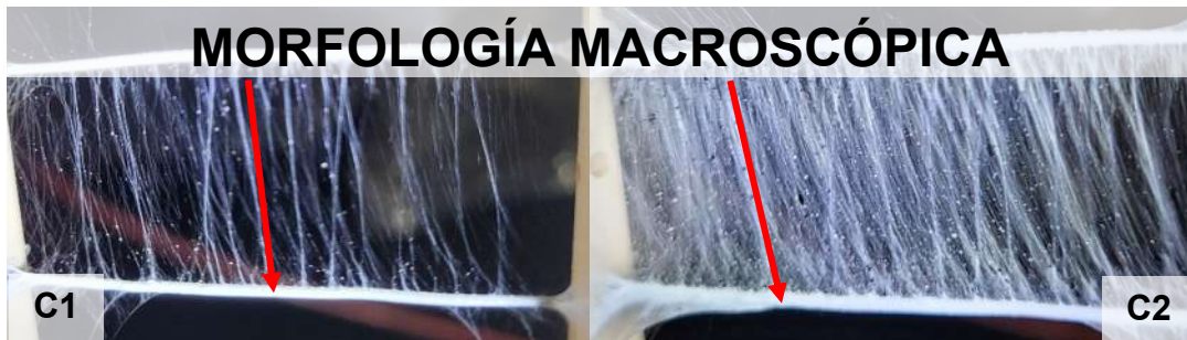
Figura 7.3. Histograma de diámetro y colecciones de nanofibras PVA-TTC, obtenidas a una distancia de trabajo de 14 cm, 14.5 kV, 0.3 mL/h, 26 °C y Hr > 40: A) histograma de distribución de diámetros de nanofibras, B) imagen FESEM, C1) 1 h de proceso, C2) 3 h de proceso.
