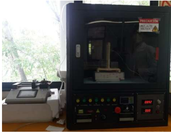
Figura 5.1. Equipo de electrohilado NaBond Technologies Co.® TL-01.
