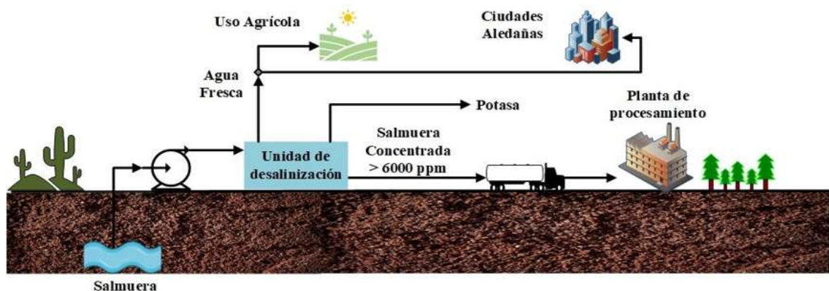
Figura 2.12 Representación de implementación de unidades de desalinización para procesamiento de salmuera de litio.
