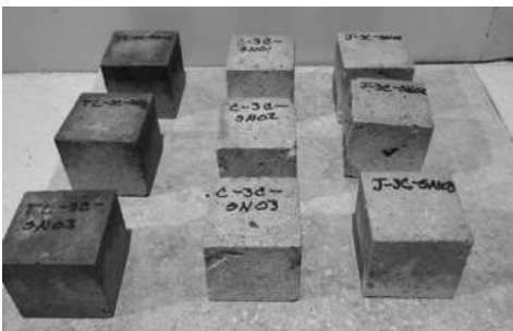
IMAGEN 91, Pérdida de humedad en roca con aplicación de biomaterial, 48 hrs, Autor FSP.
