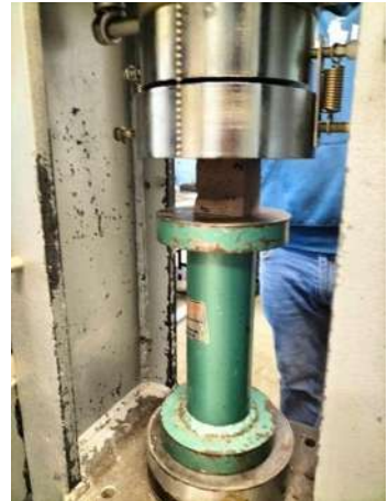
IMAGEN 99, Prueba de resistencia simple en rocas, Autor FSP.
