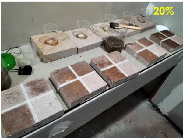
IMAGEN 41, Aplicación de biomaterial en muestras de roca ignimbrita de diferentes dosificaciones, Autor FSP.
