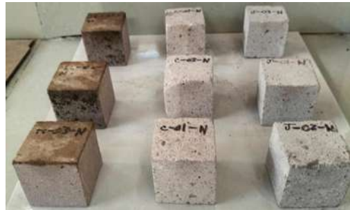
IMAGEN 90, Pérdida de humedad en roca al natural, 12 hrs, Autor FSP.
