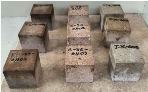
IMAGEN 89, Pérdida de humedad en roca con aplicación de biomaterial, 12 hrs, Autor FSP.
