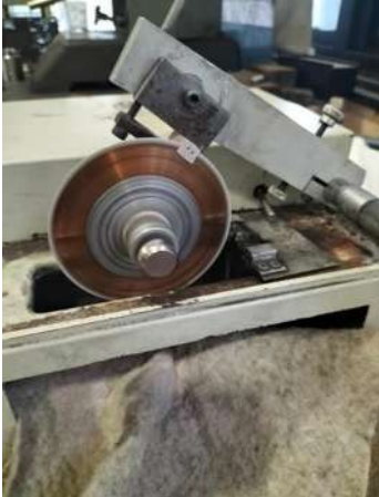
IMAGEN 78, Proceso láminas delgadas, Autor FSP.
