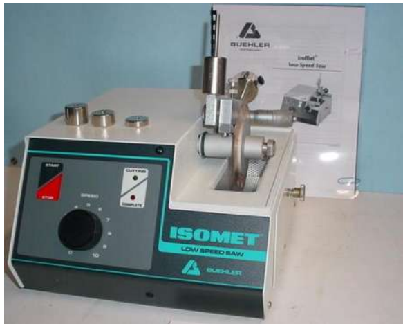
IMAGEN 73, sierra de precisión alimentada por gravedad IsoMet Low Speed, Autor FSP.
