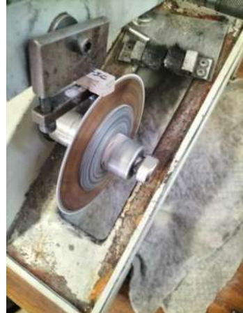
IMAGEN 77, Proceso láminas delgadas, Autor FSP.
