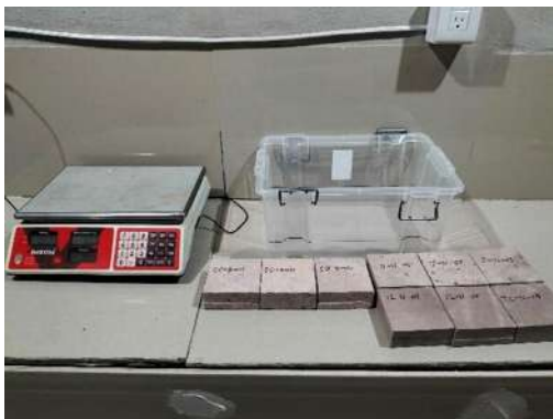
IMAGEN 52, Medición de peso inicial y final de recipientes de experimentación de roca al natural, Autor FSP.
