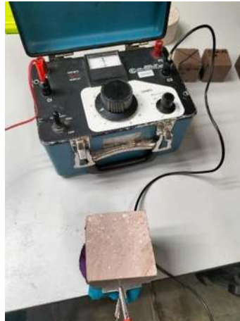
IMAGEN 44, Resistividad en rocas, Autor FSP.
