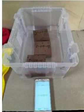
IMAGEN 63, Experimentación de saturación de agua en rocas, Autor FSP.
