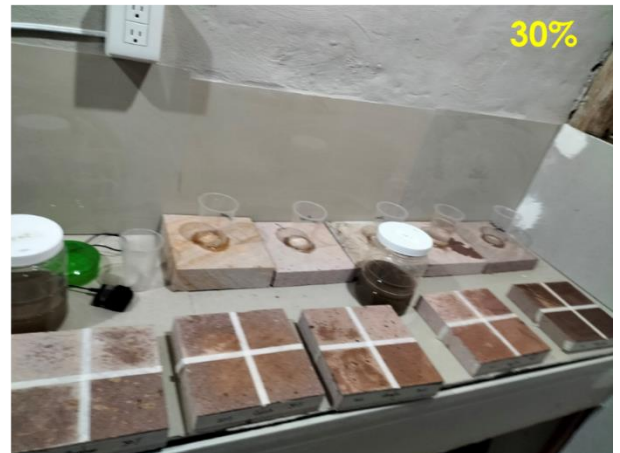
IMAGEN 41, Aplicación de biomaterial en muestras de roca ignimbrita de diferentes dosificaciones, Autor FSP.
