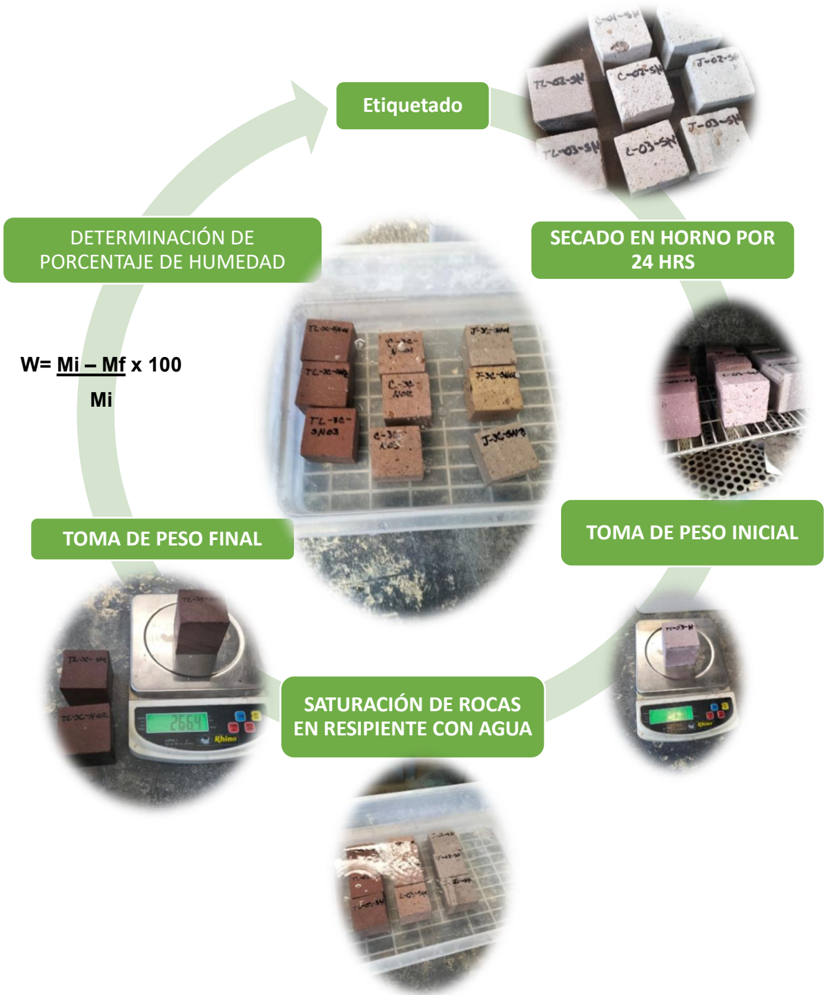
DIAGRAMA 10, Procedimiento para la obtención del contenido de humedad máxima en roca ignimbrita, Autor FSP.
