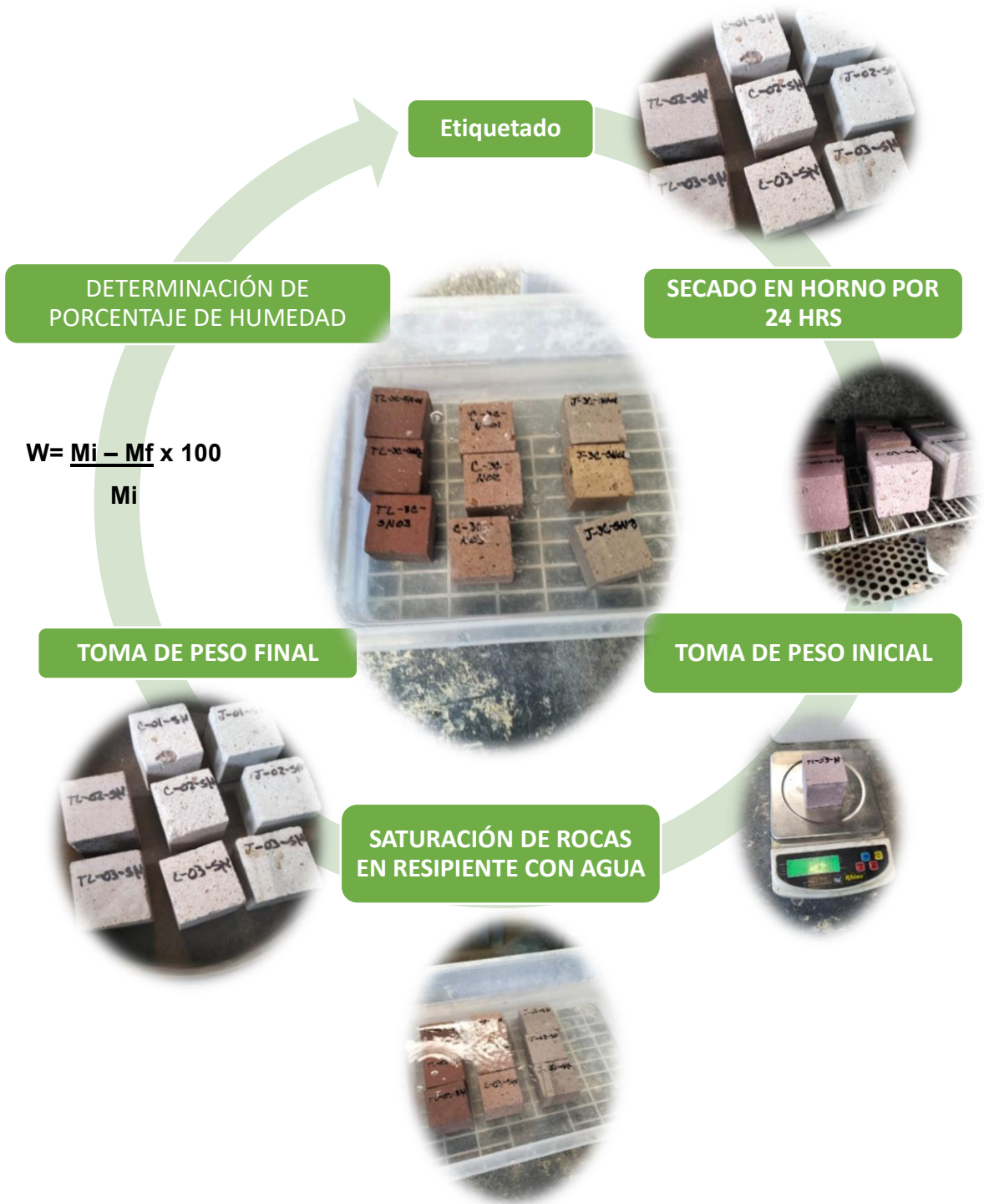
DIAGRAMA 12, Procedimiento para la obtención de la humedad de absorción en roca ignimbrita, Autor FSP.
