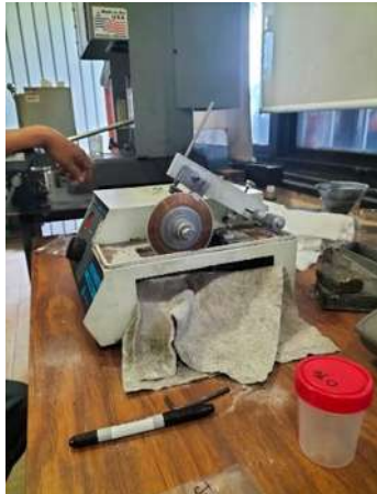
IMAGEN 79, Proceso láminas delgadas, Autor FSP.
