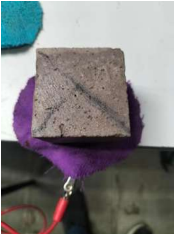
IMAGEN 45, Resistividad en rocas, Autor FSP.
