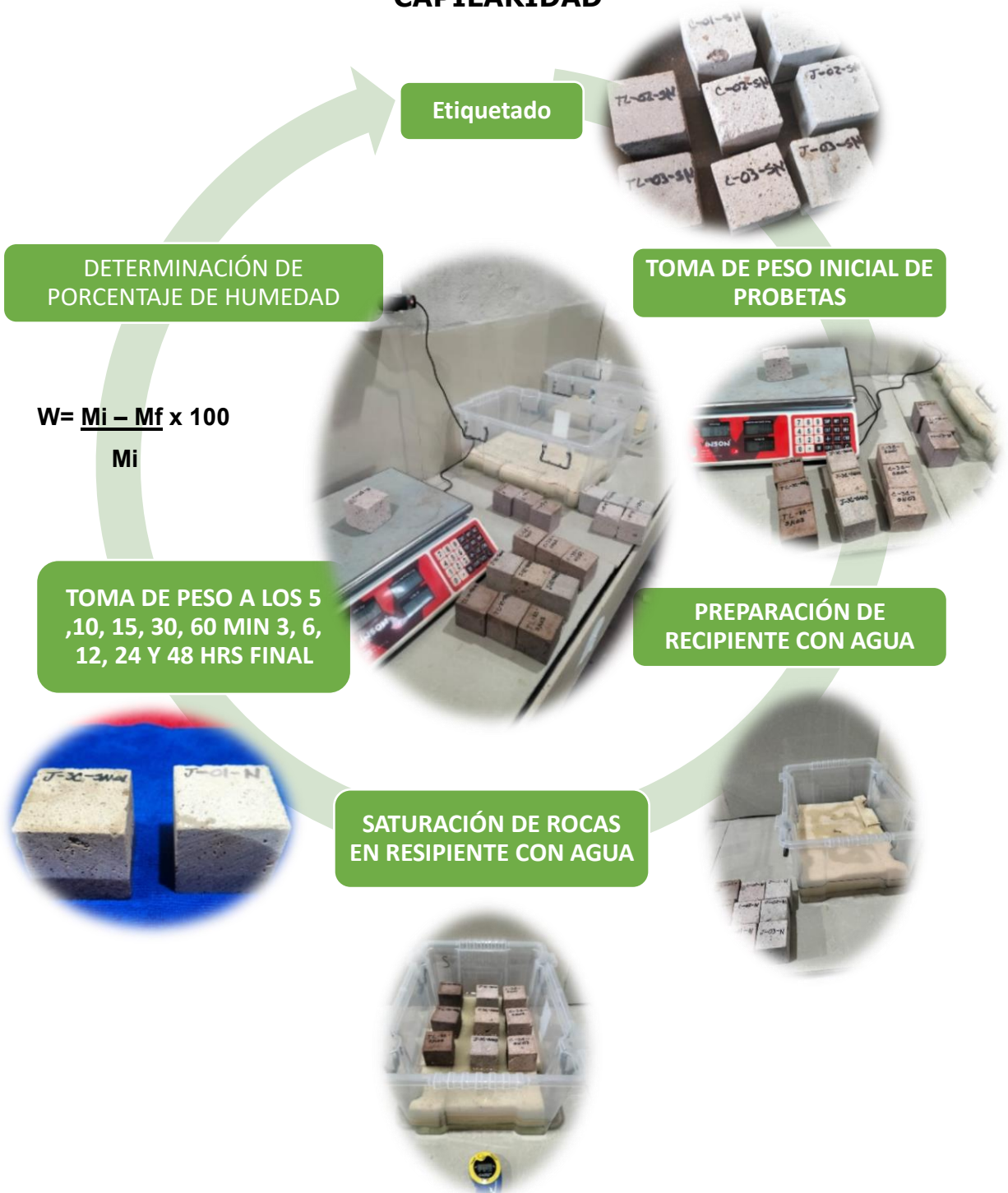
DIAGRAMA 14, Procedimiento para la determinación de humedad de absorción por capilaridad, Autor FSP.
