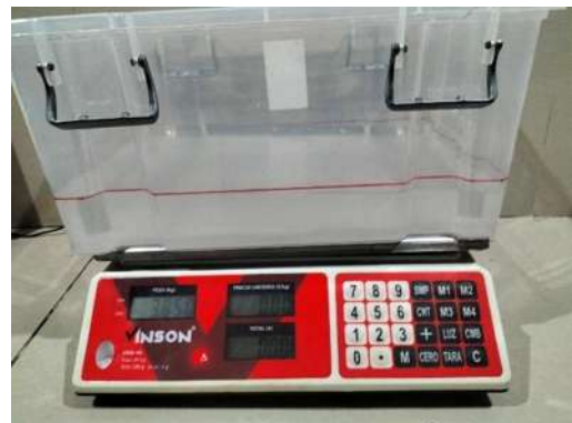
IMAGEN 52, Medición de peso inicial y final de recipientes de experimentación de roca al natural, Autor FSP.
