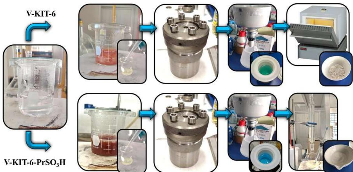
Figura 3.3: Síntesis de los materiales V-KIT-6 y V-KIT-6-PrSO<sub>3</sub>H.
