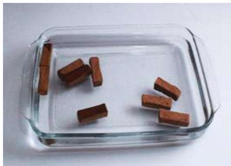
**Imagen 57** Prueba resistencia al agua uinumo urhukata \_almidón.
