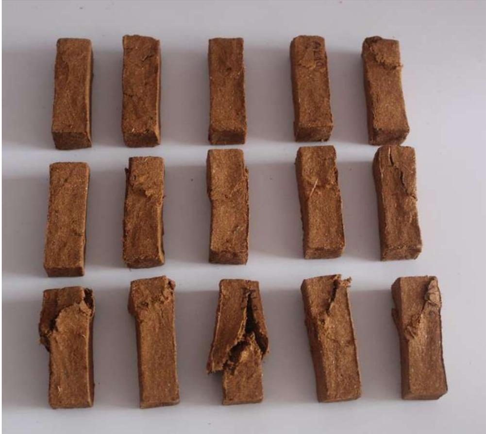
**Imagen 56.** Resultados probetas para caracterización uinum urhukata - almidón
