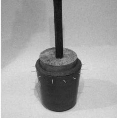
Molde de plástico con un apoyo de concreto, no resultó ya que se oxido el material
