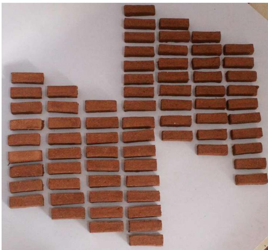
**Imagen 48** Biomaterial de uinumo urhukata de almidón y agar – agar para la caracterización, medidas específicas para laboratorio
