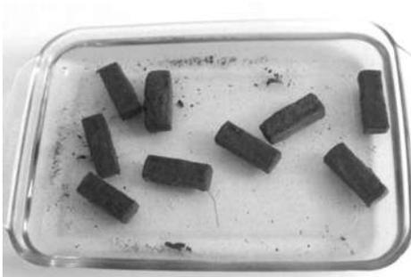
**Imagen 61** Prueba resistencia al agua uinumo urhukata agar/agar
