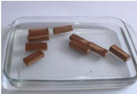
**Imagen 60.** Prueba resistencia al agua uinumo urhukata agar/agar
