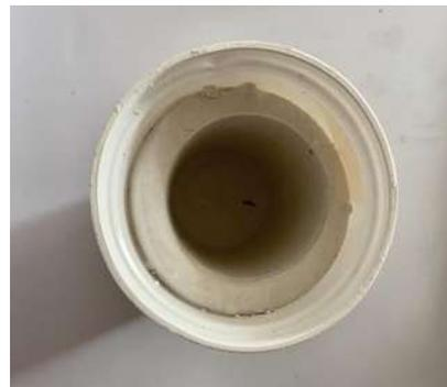
Molde de yeso, el secado es más rápido pero el desmolde complicado, necesita un desmoldante.
