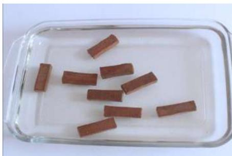
**Imagen 58** Prueba resistencia al agua a 12 horas uinumo urhukata \_almidón
