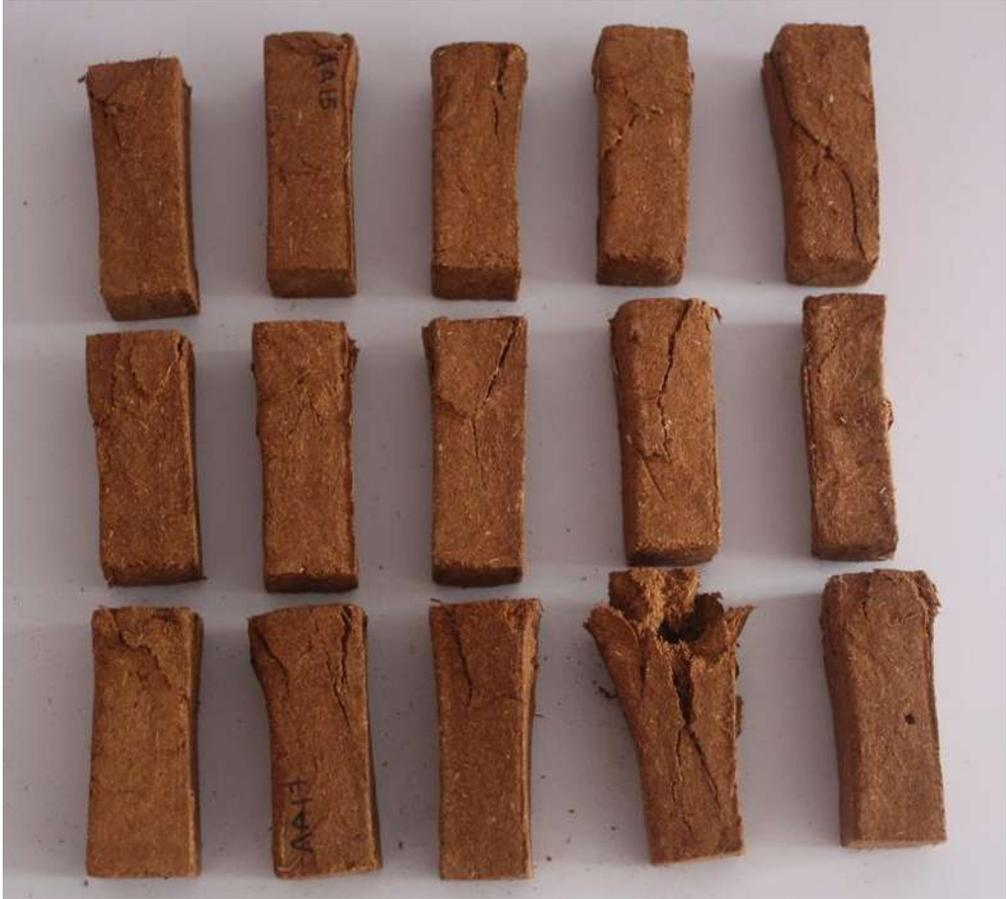
Imagen 54 Resultados probetas para caracterización uinumo urhukata - almidón
