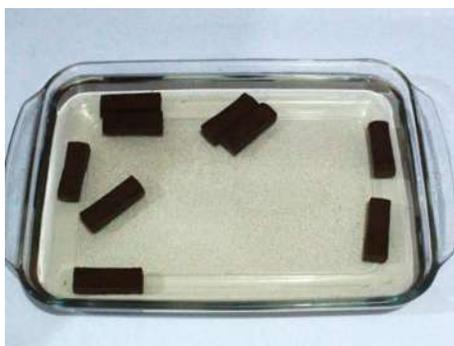
**Imagen 59** Prueba resistencia al agua a 24 horas uinumo urhukata \_almidón
