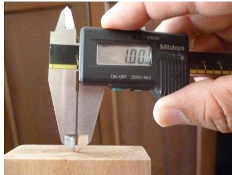
Figura 5.16 Impresión del vernier Mitutoyo en el material madera para referencia de la calibración.
