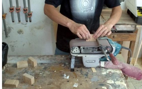
Figura 5.3. Pre-rectificado de las probetas de Fraxinus americana , L (Fresno americano) por medio de una lijadora de banda.
