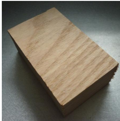
Figura 5.2. Probeta de 4 x 6.5 x 2.5 cm.
