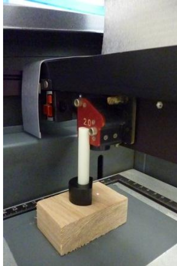
Figura 5.7 Enfoque de probeta con el cabezal móvil portador del haz.
