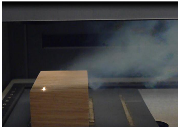
Figura 5.8 Proceso de grabado láser de líneas sobre la probeta a una potencia de 100% v velocidad de 4%.
