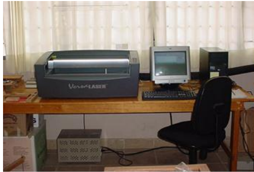
Figura 5.6 Equipo laser de CO 2 del laboratorio de grabado laser y análisis de imágenes de la FITECMA.
