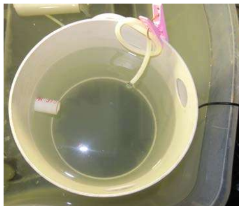
Figura 3. Incubadora cilíndrica de PVC con capacidad de 6.3 litros para incubación de huevos y mantenimiento de larvas de C. estor .
