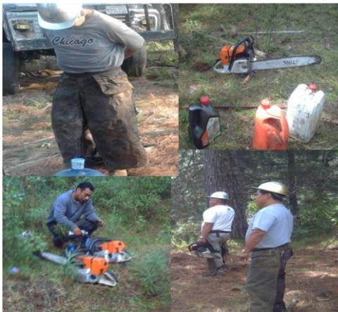
Figura 6.2.-Equipo de trabajo y de seguridad del motosierrista
