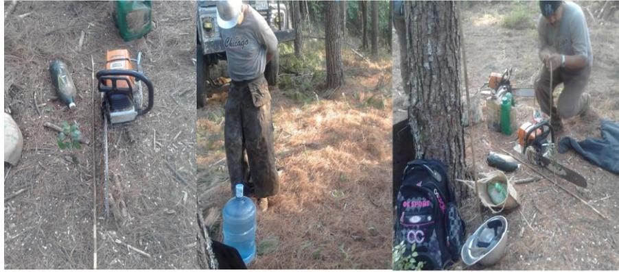
Figura 5.4.- Equipo y herramientas de trabajo de un motosierrista
