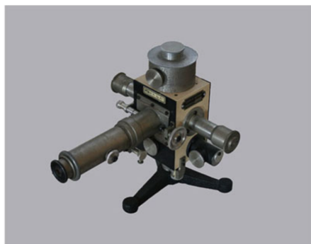
Figura 1.2: Fotografía del electroscopio utilizado por T. Wulf en 1912 [19].
