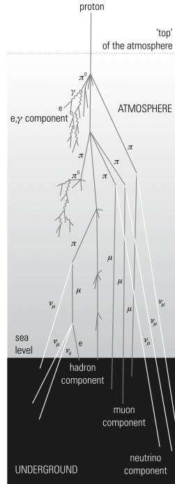
Figura 3.1: Componentes de los chubascos de partículas. Un protón incide en la atmósfera como partícula primaria y produce subcascadas de distinta naturaleza [42].
