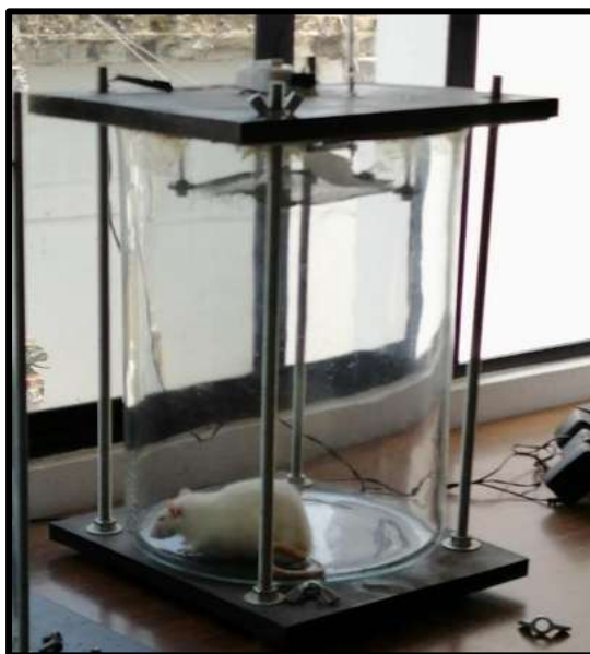
Figura 8. Cámara de exposición estática de 29 L; es un sistema cerrado que cuenta con un puerto de inyección y un ventilador para homogenizar la concentración de tolueno.
