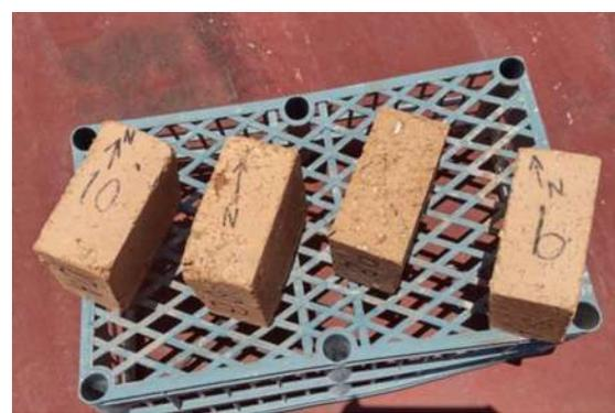
Figura 32. Bloque de Tierra Comprimida (BTC) a la intemperie a los 6 meses.
