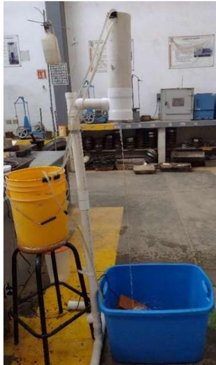
**Figura 24.** Equipo utilizado en ensayo de erosión
