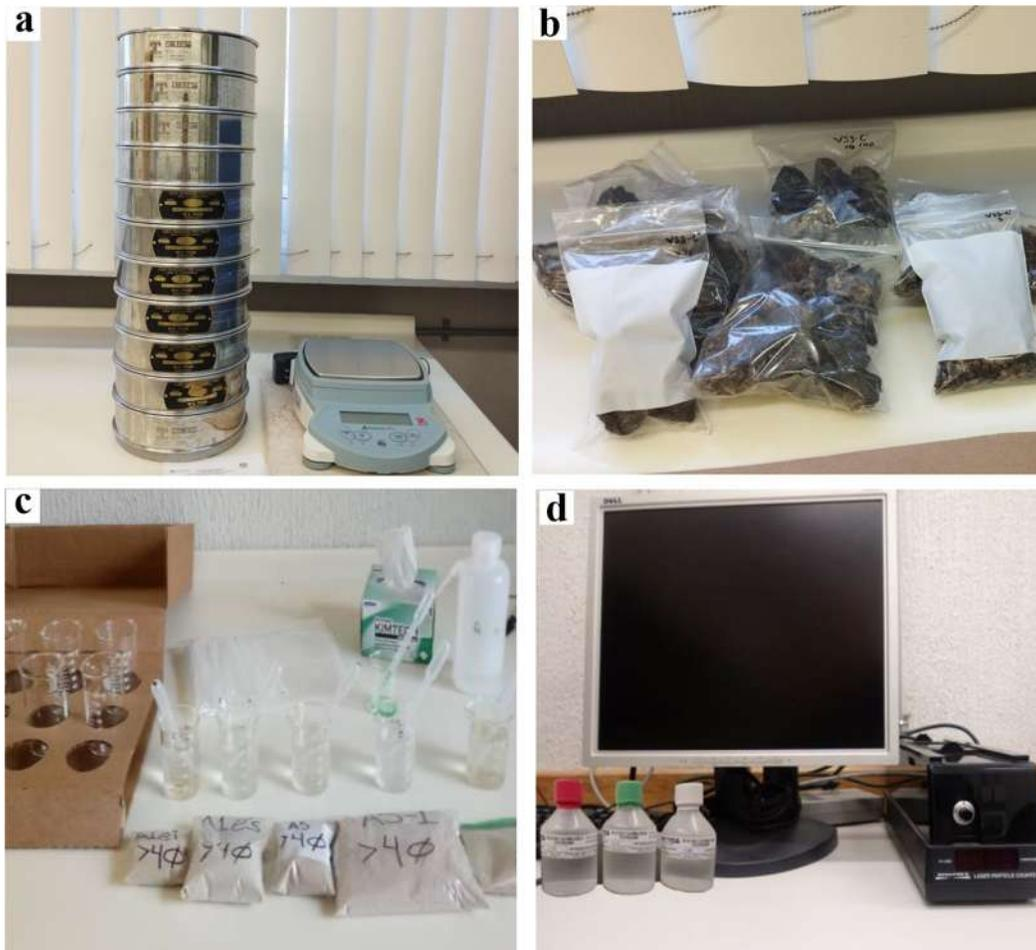
Figura 6.- Procedimiento granulométrico. a) juego de tamices y báscula de alta precisión, b) recuperación de las fracciones granulométricas, c) granulometría de fracciones finas, d) equipo de conteo de fracciones finas.
