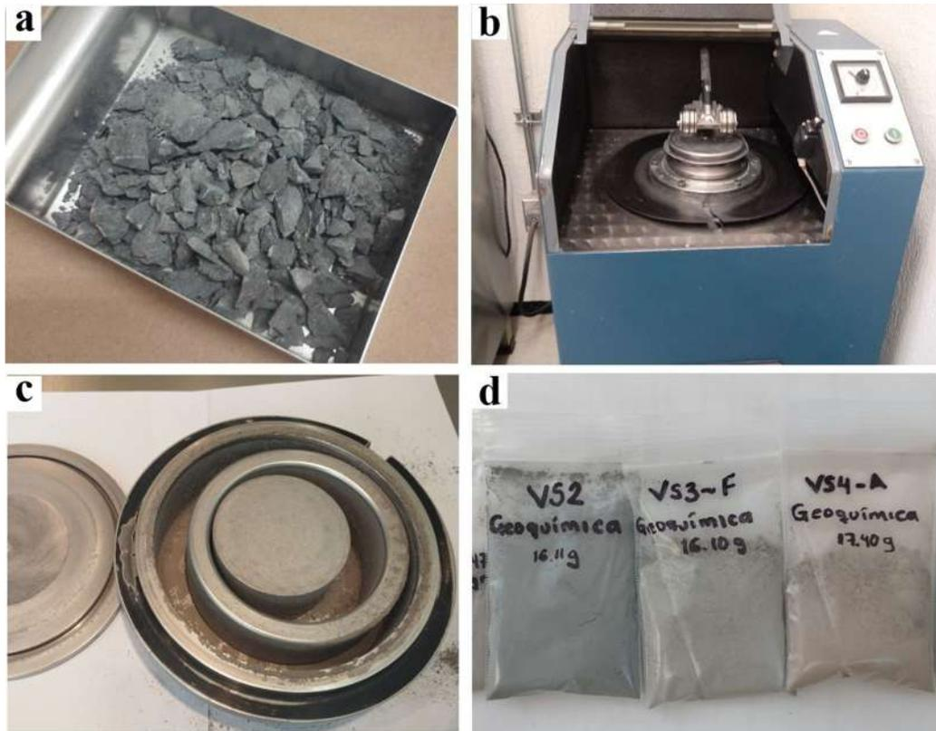
Figura 5.- Preparación de muestras para geoquímica a) esquirlas de dique; b) equipo HERZOG; c) contaminación del mortero y d) muestras recuperadas.
