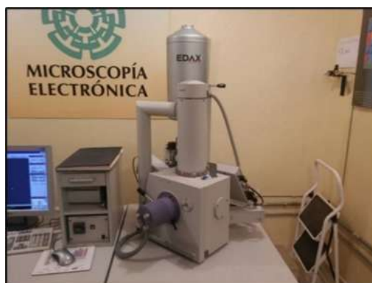
Figura 19 MEB JEOL JSM 5300 utilizado en la caracterización
