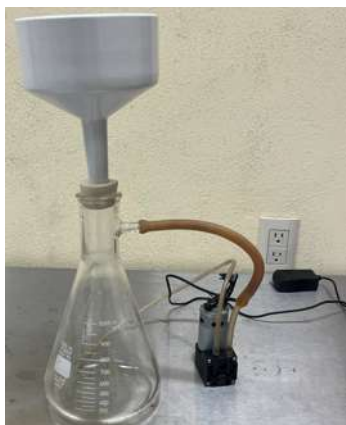
Figura 34 Matraz Kitasato con bomba de vacío para separar la parte sólida de la líquida
