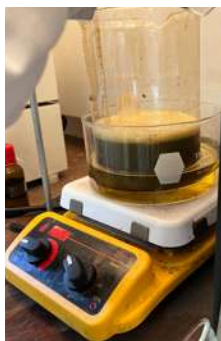
Figura 14 Solución para sintetizar OG en baño de aceite a 40^\circ C
