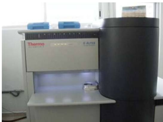
Figura 20 Espectroscopio de fotoelectrones de rayos X K-Alpha Thermo Scientific utilizado para la caracterización
