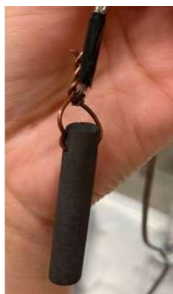
Figura 28 Electrodo de grafito unido a cable de estaño
