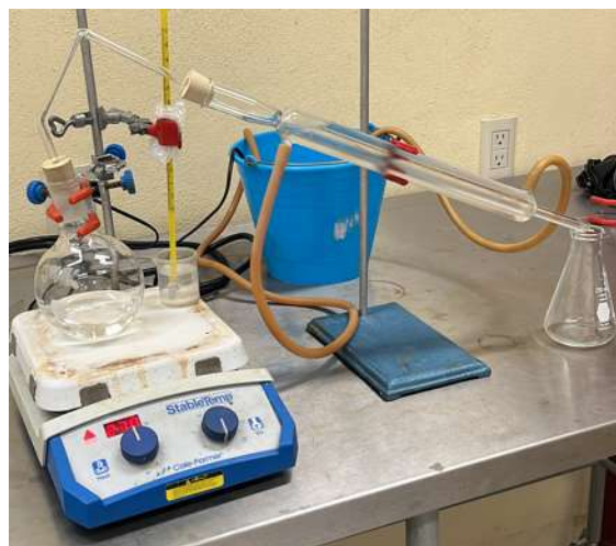
Figura 36 Equipo de destilación para separar el hexano de la muestra
