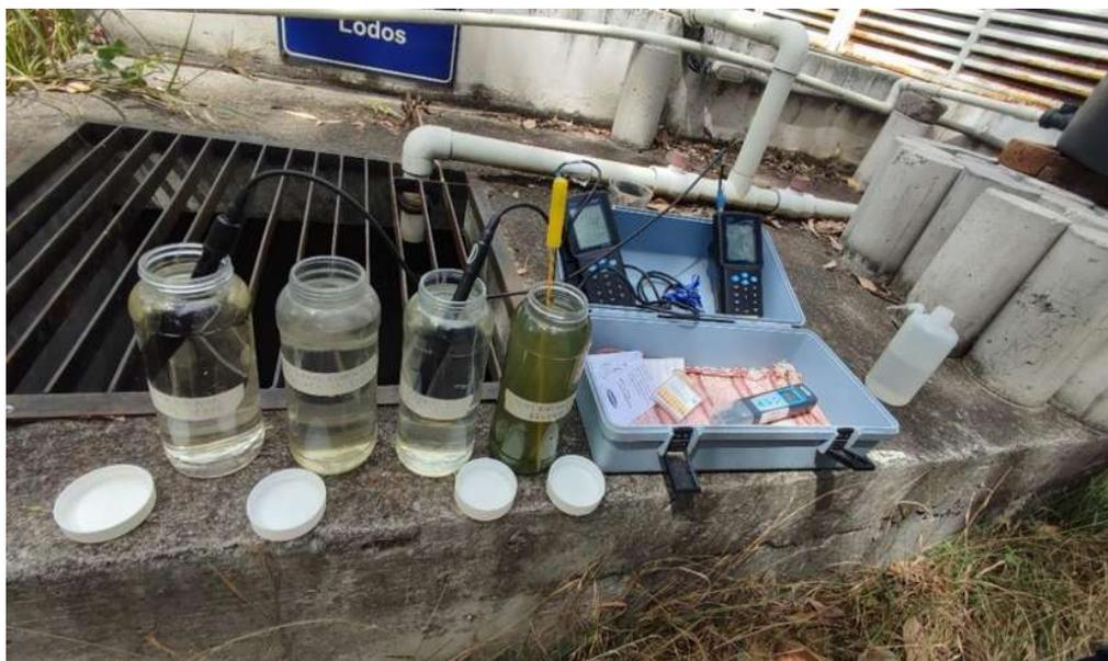
**Ilustración 25.** Obtención de los parámetros de campo de las cuatro muestras.
