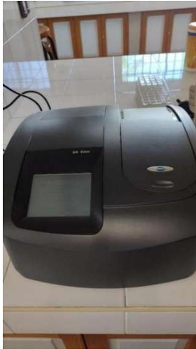
**Ilustración 41.** Lecturas del fósforo total con el espectrofotómetro DR5000.
