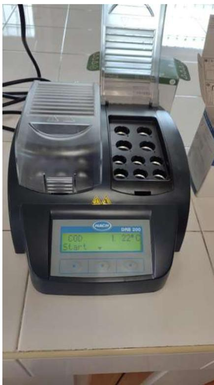
**Ilustración 30.** Reactor de digestión DRB200.
