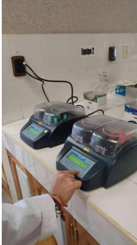
**Ilustración 32.** Reactor de digestión DRB200 a temperatura de 120°C con las muestras.
