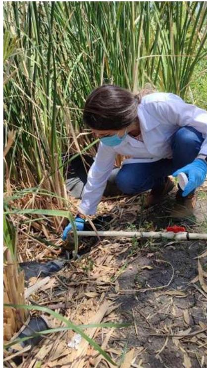
**Ilustración 23.** Toma de muestra a la entrada del humedal.
