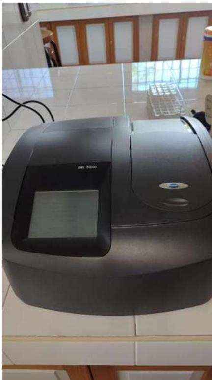
**Ilustración 35.** Lecturas de las concentraciones del nitrógeno total en el espectrofotómetro DR5000.
