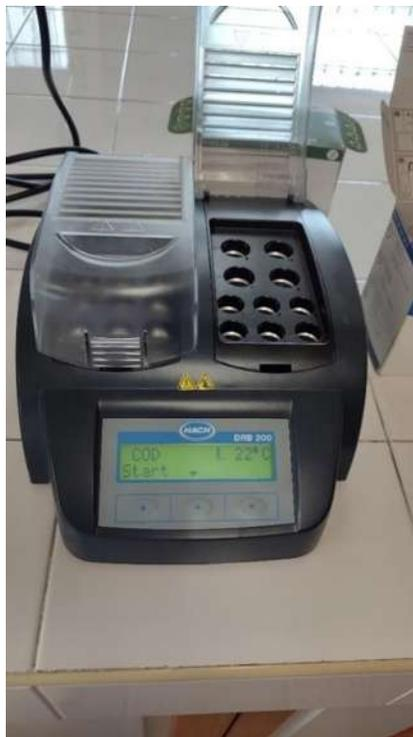
**Ilustración 36.** Reactor de digestión DRB200 a una temperatura de 100°C.
