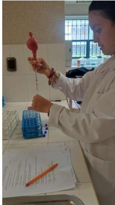
**Ilustración 34.** Dosificación de la muestra digerida.
