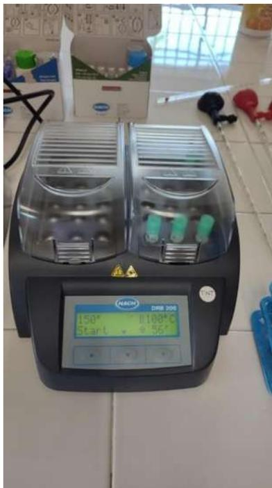
**Ilustración 39.** Reactor a temperatura de 100°C durante 60 minutos.
