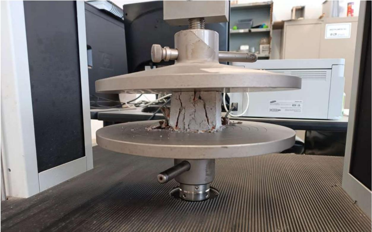
Figura 113: Prueba de resistencia a la compresión.
