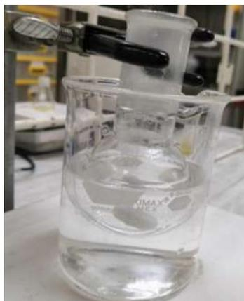
**Figura 55. Sistema utilizado para conocer el perfil de liberación del ácido fólico contenido en nanofibras de carboximetilcelulosa-óxido de polietileno a distintos pH (1.5, 6 y 7.8) similar al pH gastrointestinal.**
