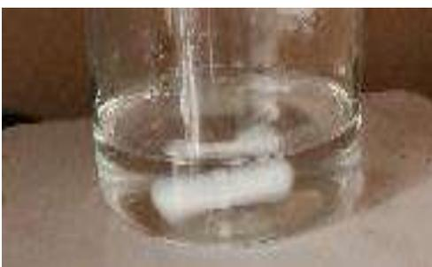
**Figura 9. Muestra representativa de la solución de carboximetilcelulosa y óxido de polietileno sin ácido fólico.**
