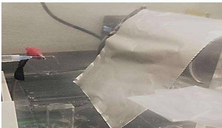
**Figura 13. Evidencia de la dificultad para electrohilar la solución CP-I.**
