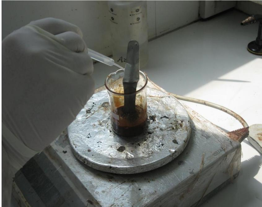
**Figura 30.-** Resina a base delignina despolimerizada/hexamina.
