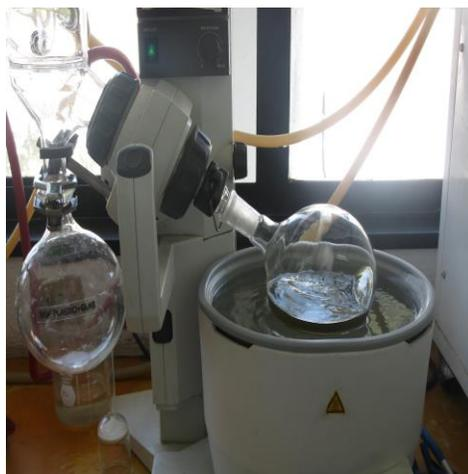
**Figura 19.-** Concentración de extractos crudos de maderas de alta durabilidad en rota-evaporador BUCHI B-490.
