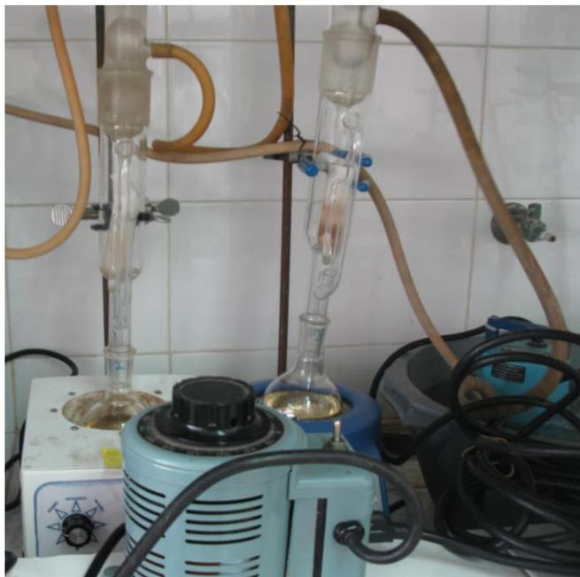
Figura 10.- Equipo Soxhlet para liberación de extraíbles mediante n-hexano.
