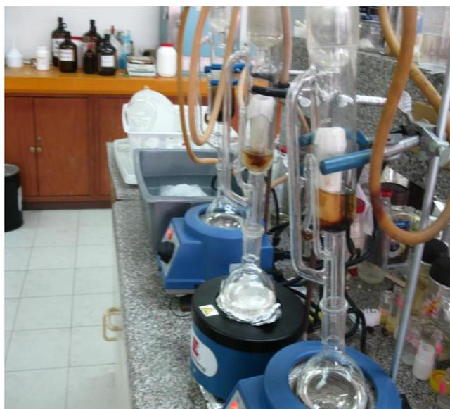
**Figura 18.-** Equipo Soxhlet usando solventes aproticos.
