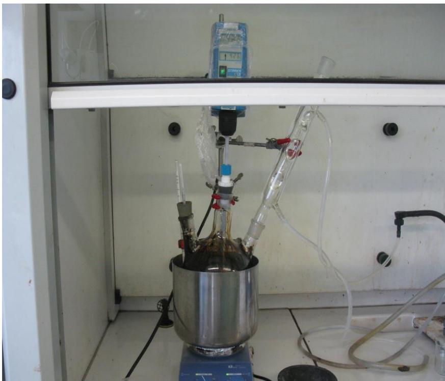
**Figura 15.-** Matraz reactor de tres cuellos equipado con un condensador, termómetro y un agitador magnético.
