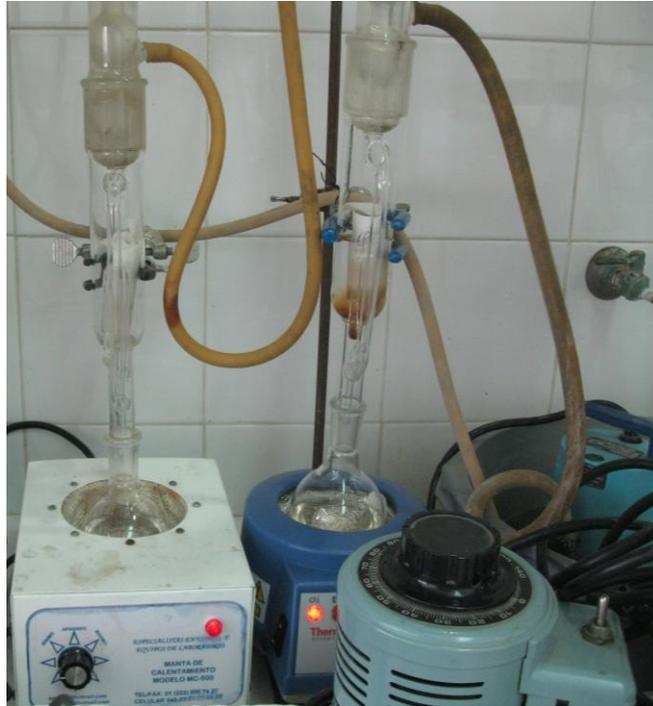
**Figura 11.-** Equipo Soxhlet para liberación de extraíbles mediante acetona.
