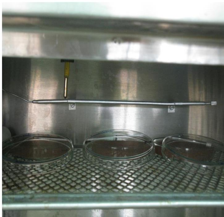
**Figura 12.-** Secado de harina de madera para liberación de extraíbles en horno de secado modelo HS-41.
