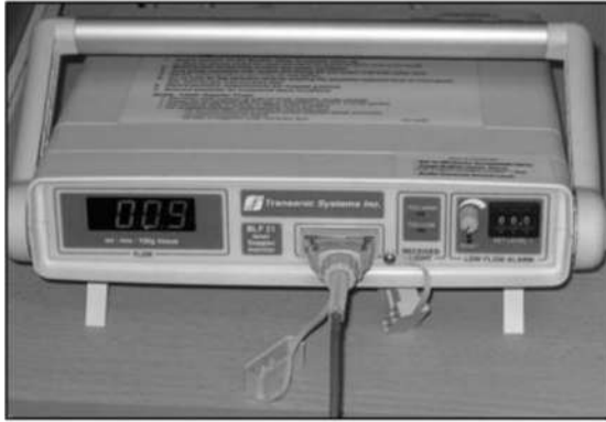
Figura 25. Flujiometría laser Doppler aparato comercial (Karayilmaz & Kirzioğlu, 2011).
