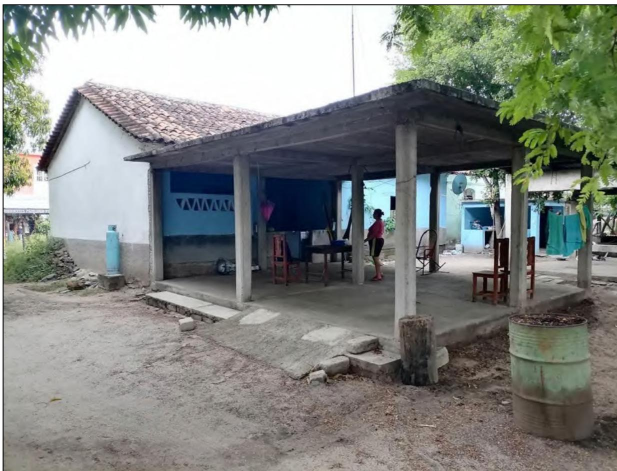
*Figura 5-10. Vivienda de adobe (etapa 1 y 2) y área de trabajo (estructura de concreto, etapa 4). Fuente: fotografía del autor, 2022.*
