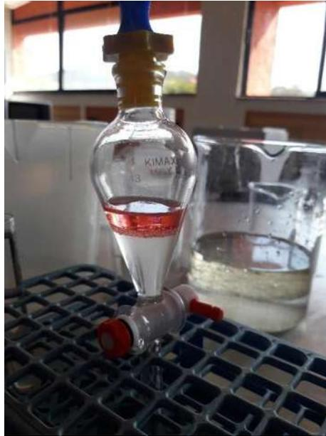
Figura 6. Separación del contenido de un tubo de ensaye para la curva de calibración.
