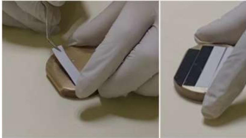
**Figura 27.-** Colocación de cinta doble cara en el porta muestras.
