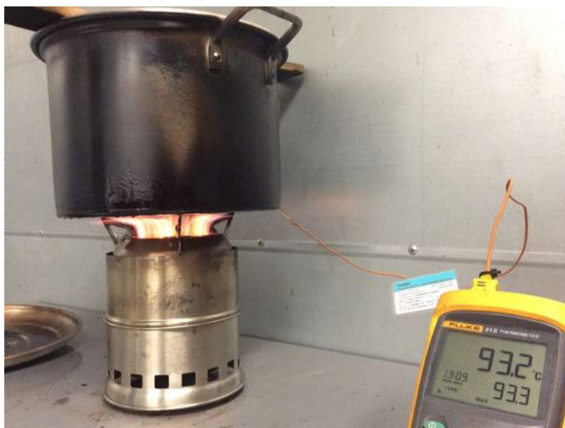
Figura 34: Prueba WBT de P-FVBW, a la máxima temperatura registrada.
