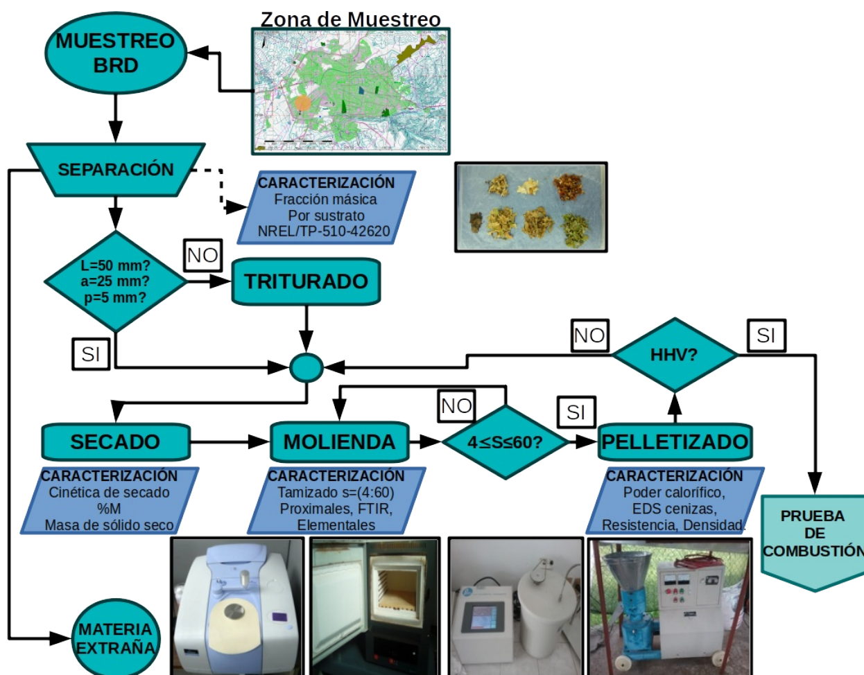
Figura 2: Caracterización de FVBW y obtención de Pellets. (S : tamaño de malla, M: humedad (%))
