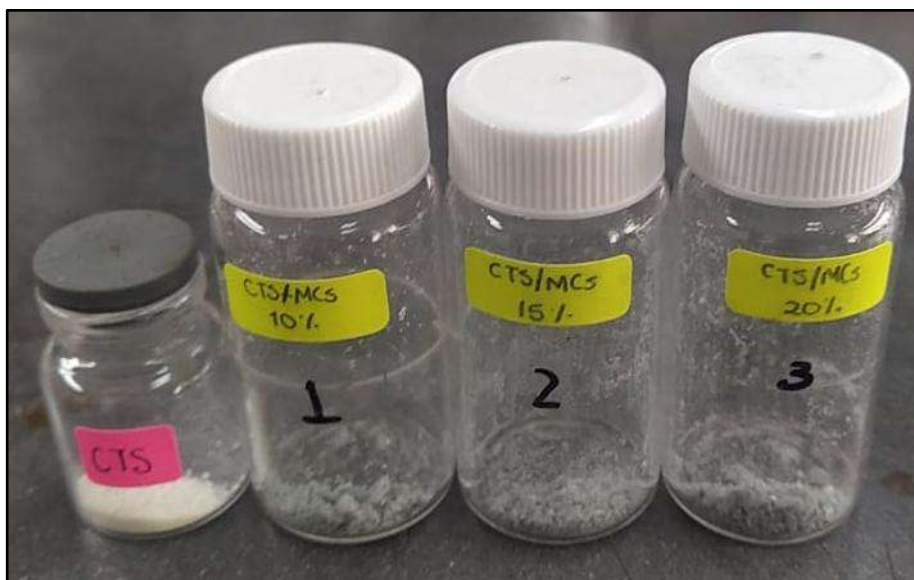
Figura 30. Materiales obtenidos mediante la inmovilización de diferentes concentraciones de MCs/PCP en polvos de CTS.
