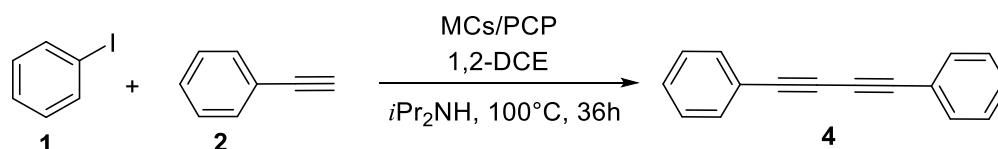
Esquema 4. Reacción de formación de enlace C—C con el uso de MCs/PCP como catalizador.
