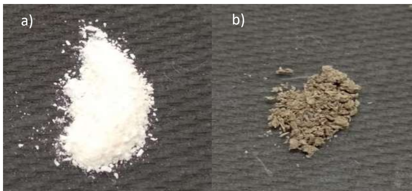
Figura 29. Polvo de CTS a) antes de la inmovilización de los microcristales de \text{Cu}_2\text{O} , b) después de la inmovilización de los microcristales de \text{Cu}_2\text{O} .
