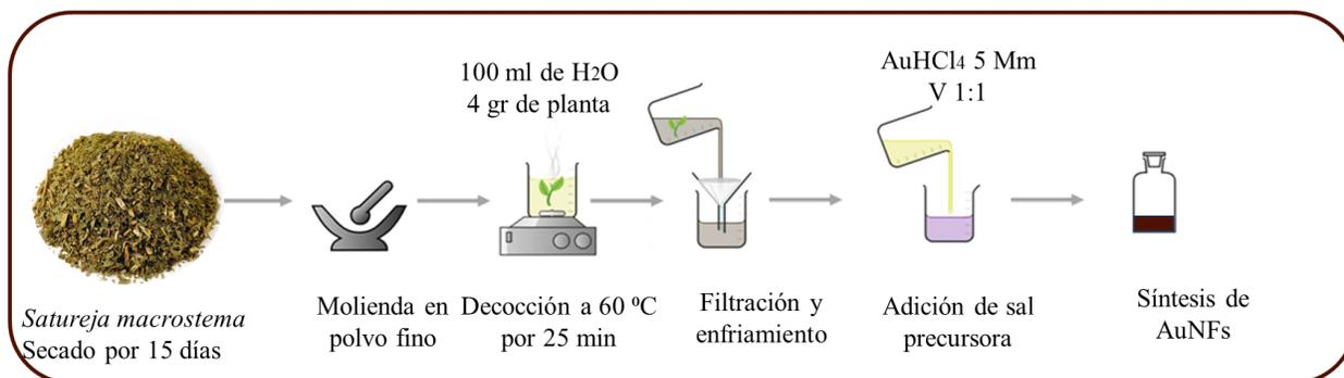
**Figura 10.** Esquema que muestra la metodología de síntesis de las nanoflores (AuNFs).
