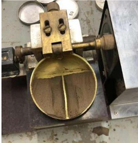
*Figura 23: Muestra en copa de Casagrande con ranura.*
