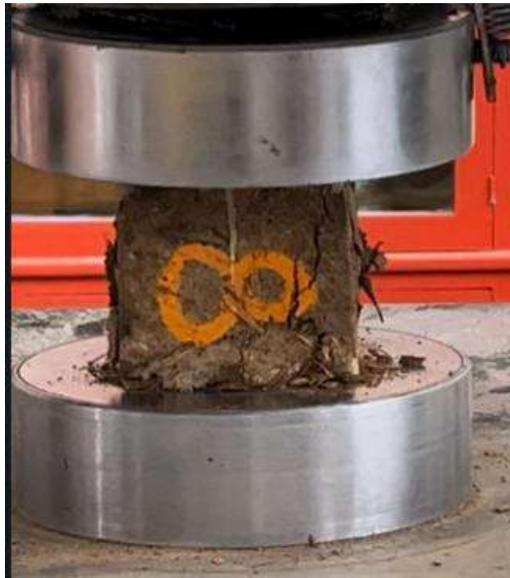
*Figura 59 Esfuerzo a compresión simple después de falla*
