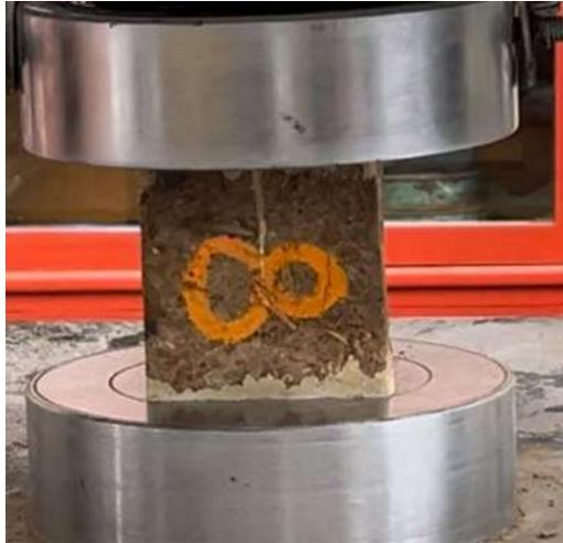
*Figura 58 Esfuerzo a compresión simple antes de falla*
