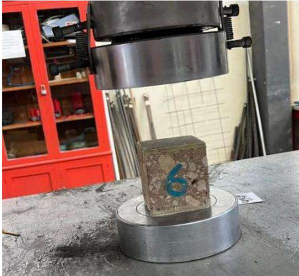
*Figura 38: Espécimen colocado en equipo para compresión.*
