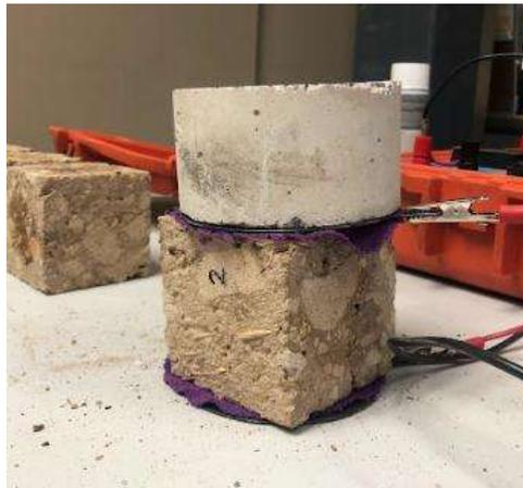
*Figura 31: Preparación del espécimen para RE*
