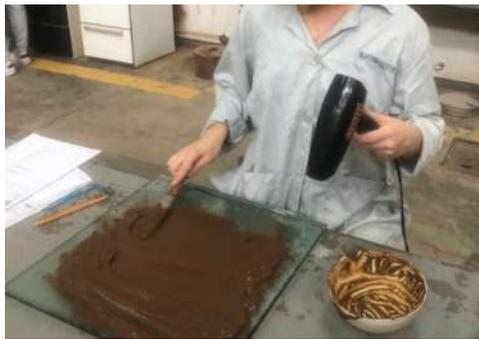
*Figura 21: Homogeneizado de la muestra.*
