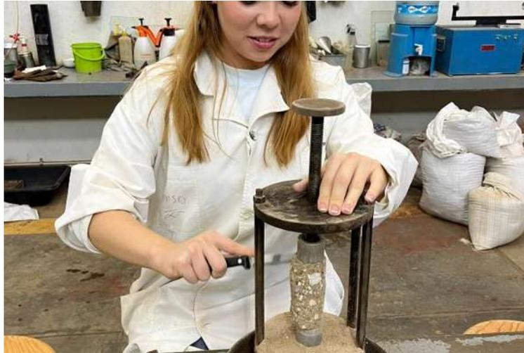
*Figura 43: Labrado de especímenes para prueba triaxial*
