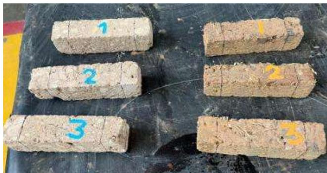
Figura 40: Vigas marcadas para probar a flexión
