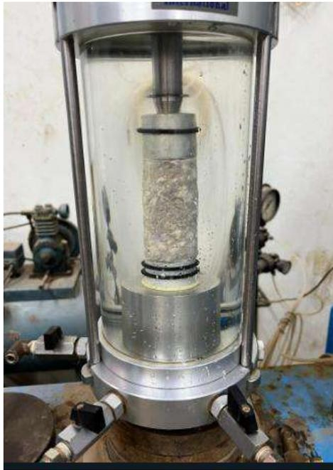
*Figura 45 Cámara triaxial colocada en prensa y llena de agua*
