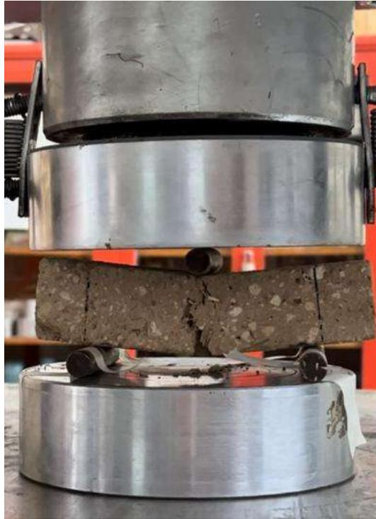
*Figura 62 Muestra M-JM-V-3 completamente fallada*
