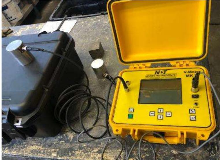
*Figura 29: Calibración y preparación del equipo de VPU*
