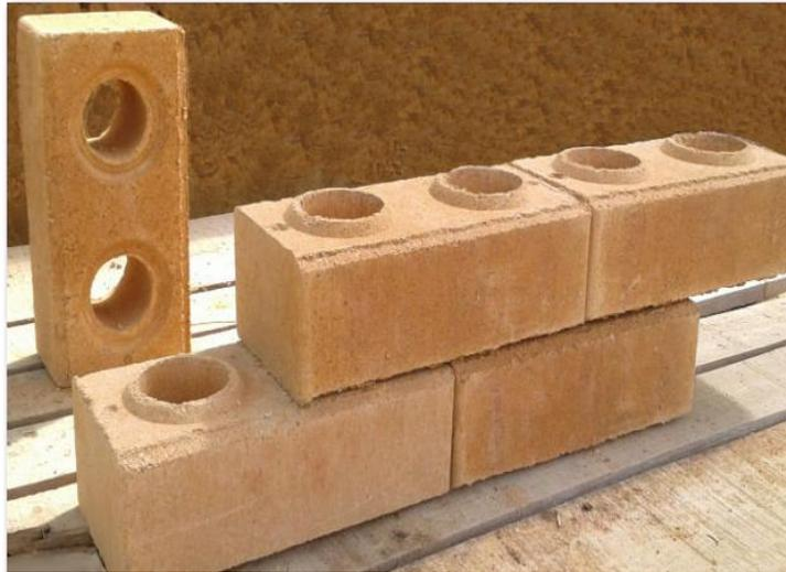
*Figura 3: Bloque de Tierra Comprimida (BTC).*
