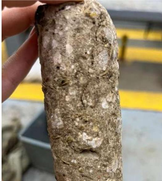
*Figura 46 Especimen fallado con presencia de grieta*
