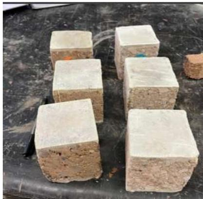
*Figura 37: Especímenes cabeceados para probar a compresión*
