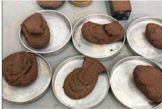
*Figura 24: Muestra LL en estado seco del suelo*
