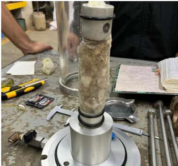
*Figura 44 Colocación de espécimen cubierto de látex*
