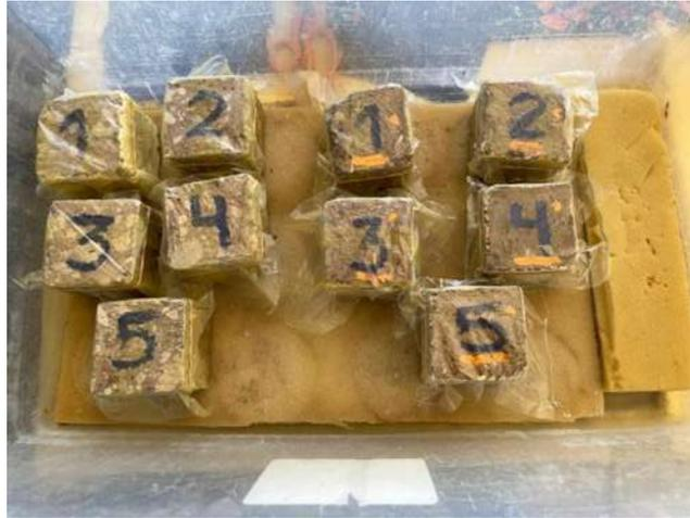
*Figura 36: Especímenes colocados para prueba de absorción*
