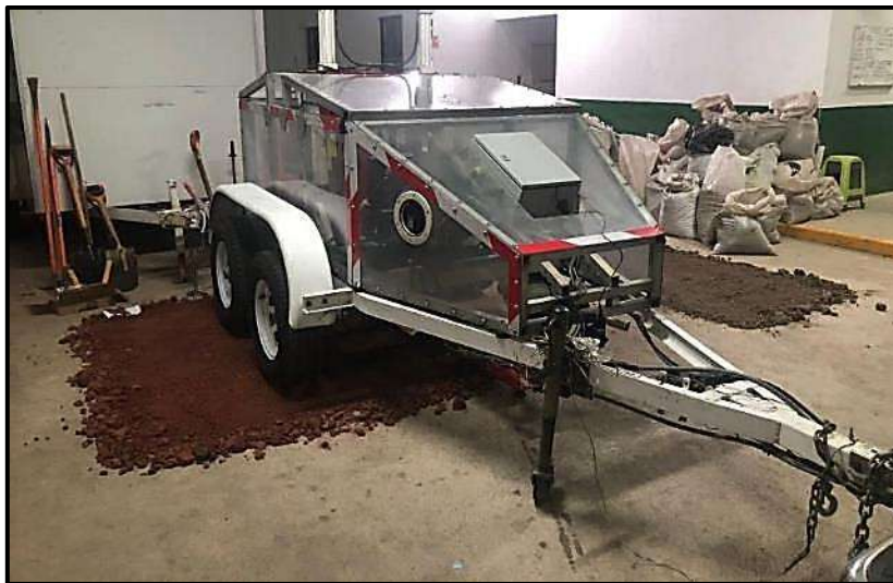
Ilustración 56. Deflectómetro de Impacto (SOINVITSA, 2023).
