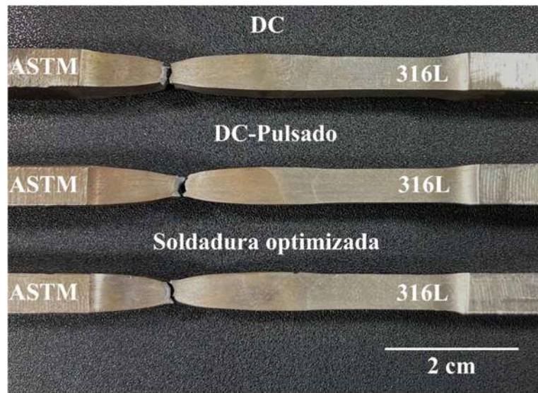
Figura 4.14 Fracturas en las probetas de los ensayos de tensión para las tres condiciones de soldadura.
