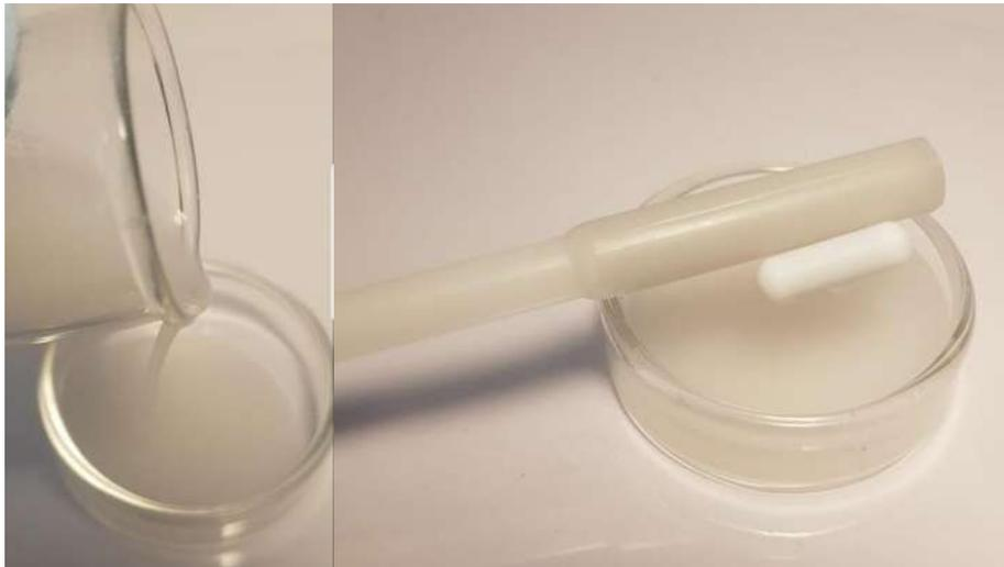
*Figura 20. Vaciado de la solución sobre la caja Petri y extracción del agitador magnético. Fuente: Elaboración propia.*
