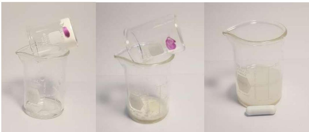
*Figura 17. Mezcla de los reactivos para la obtención de las películas de hidrogel. Fuente: Elaboración propia.*
