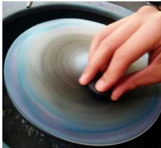
Figura 3.13 Pulido con pasta de diamante de 1 micra.
