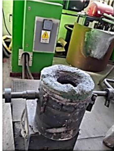
Figura 3.3 Horno de inducción con capacidad de 30 kilogramos utilizado para la fusión de las aleaciones de hierro.
