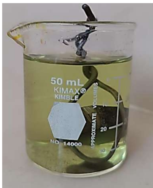
Figura 3.17 Ataque profundo sumergida muestra Base dinámica en condiciones de colada sumergida en la solución 8 gramos de FeCl_3 , 20 ml de HCl y 930 ml de etanol por un tiempo de 6 horas.
