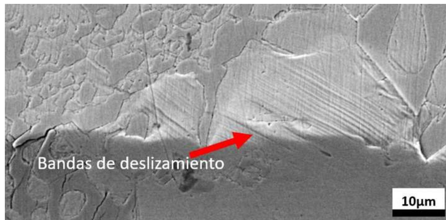
Figura 4.55 Bandas de deslizamiento, micrografía vista superior huella de desgaste por una sola rayadura (22N, 4.3 mm/s) aleación 1Ti solidificación estática en condiciones de colada.
