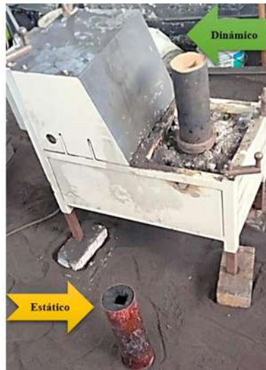
Figura 3.6 Molde montado en la máquina para la solidificación dinámica y molde para solidificación estática.
