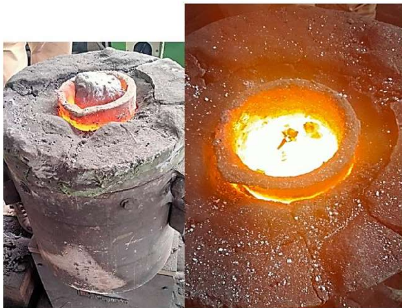
Figura 3.7 Crisol cargado con sorel en el proceso de fusión.
