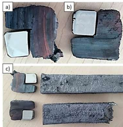
Figura 3.9 a) Corte para las muestras de solidificación estática, b) Corte de las muestras con solidificación dinámica, y c) Cortes transversales de ambos lingotes.
