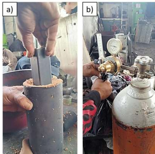
Figura 3.4 a) Moldeado en arena para la solidificación dinámica, b) Introducción del gas \text{CO}_2 en el molde.
