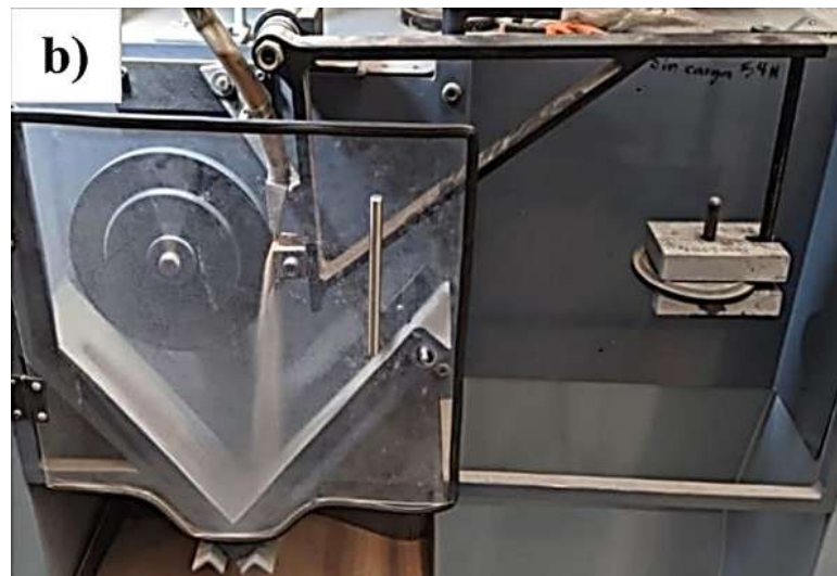
Figura 3.24 Ensayo de desgaste abrasivo.
