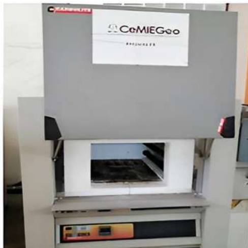
Fig. 3.10 Horno eléctrico marca Carbolite para tratamientos térmicos.
