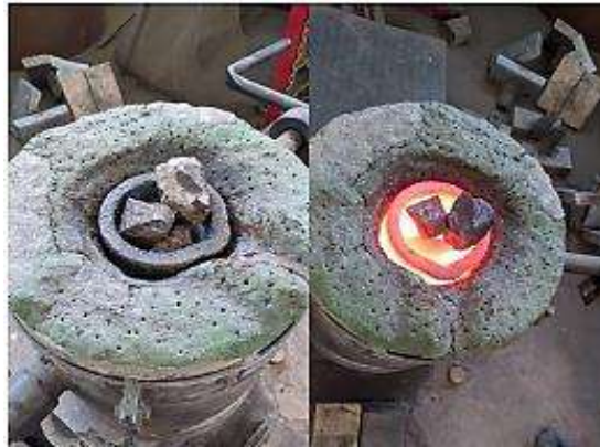
Fig. 3.7 Crisol con los elementos de aleación antes y en el transcurso de la fundición.
