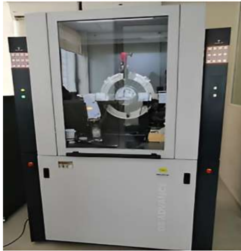
Fig. 3.16 Difracción de rayos- X marca Bruker® modelo D8 Advance.
