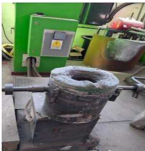
Fig. 3.2 Horno de inducción con capacidad de 30 Kg para la fundición de aleaciones.
