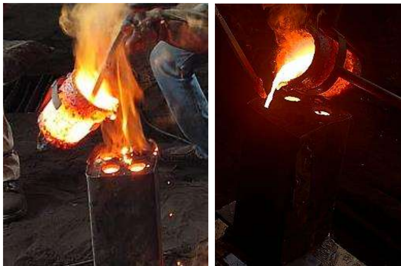
Fig. 3.8 Vaciado del metal líquido en molde de arena.
