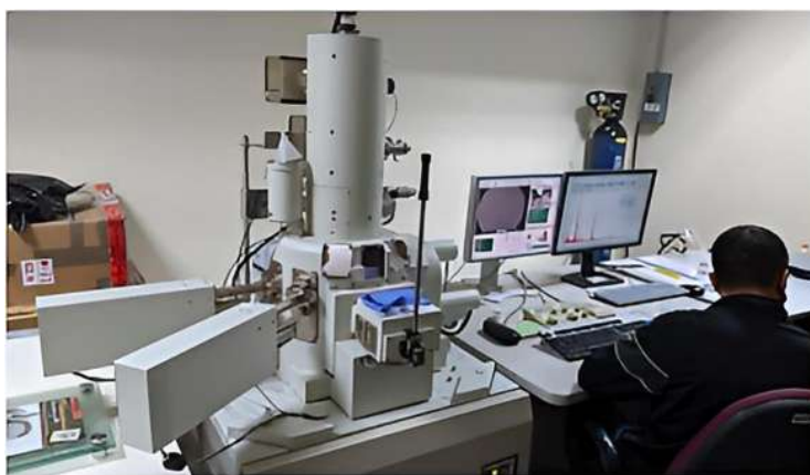
Fig. 3.15 Microscopio electrónico de barrido marca Joel modelo 7600.
