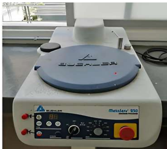
Fig. 3.12 Pulidora marca Buehler modelo MetaServ 250.
