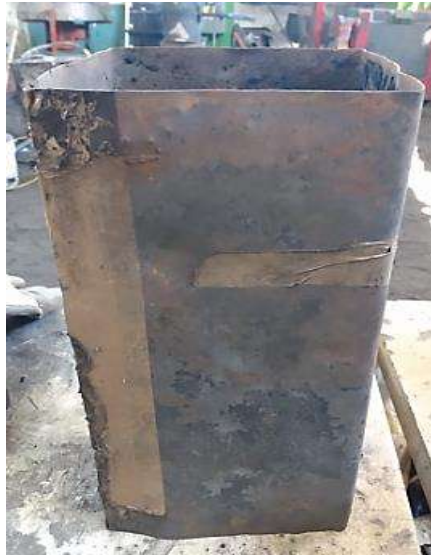
Fig. 3.3 Caja metálica para la fabricación de las barras.
