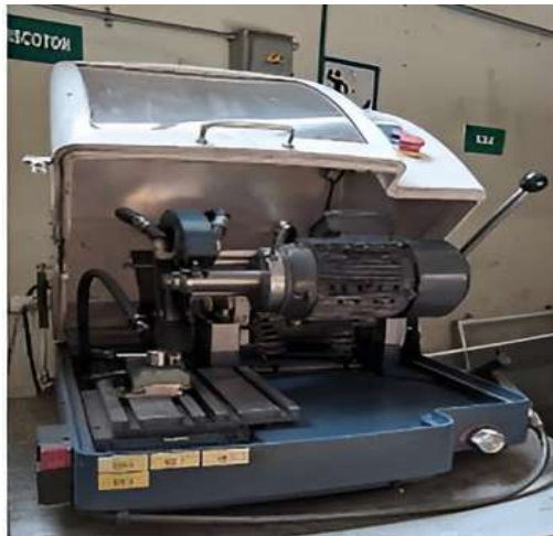
Fig. 3.9 Cortadora metalográfica Buehler modelo AbrasiMet 250.
