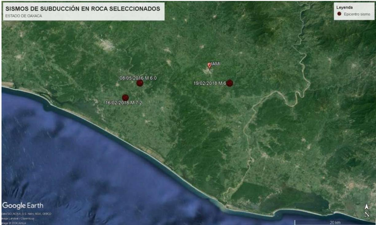
Figura 2.32 Ubicación de la estación de los registros acelerográficos con distancia epicentral menor a 50 km y de los epicentros de los sismos correspondientes de estos
