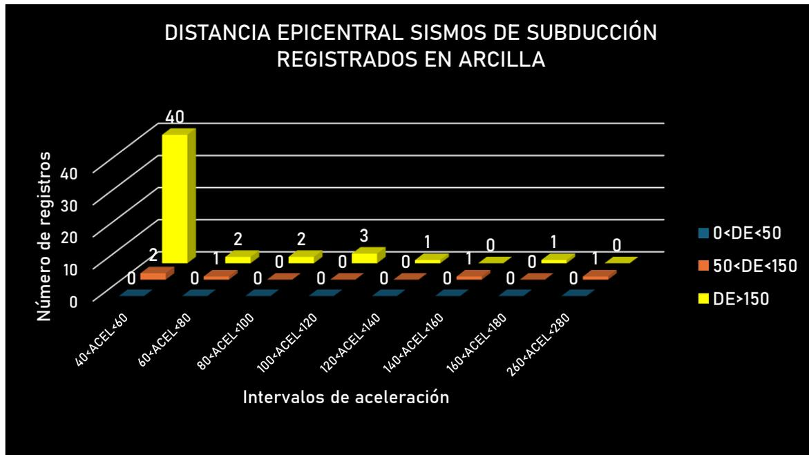
Figura 2.25 Registros de aceleración para sismos de subducción registrados en arcilla con aceleración mayor a 40 gal e intervalos de distancia epicentral
