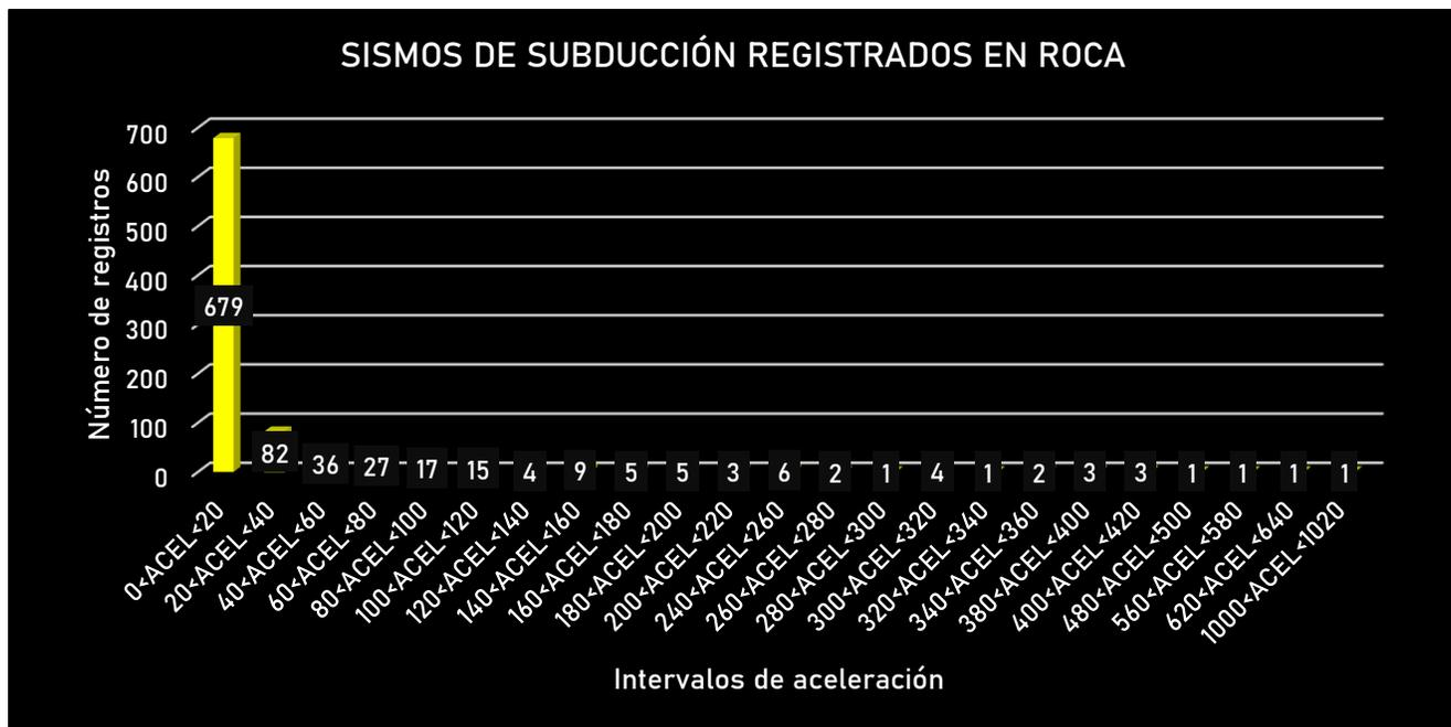
Figura 2.12 Registros de aceleración de sismos de subducción registrados en roca y divididos por intervalos de aceleración.
