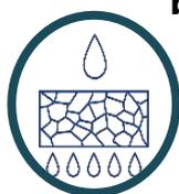
**b) PAVIMENTOS PERMEABLES:** Se trata del uso de materiales permeables en calles, banquetas y estacionamientos para que el agua de lluvia se filtre lentamente en el suelo en lugar de convertirse en escorrentía. (Figura 55).
