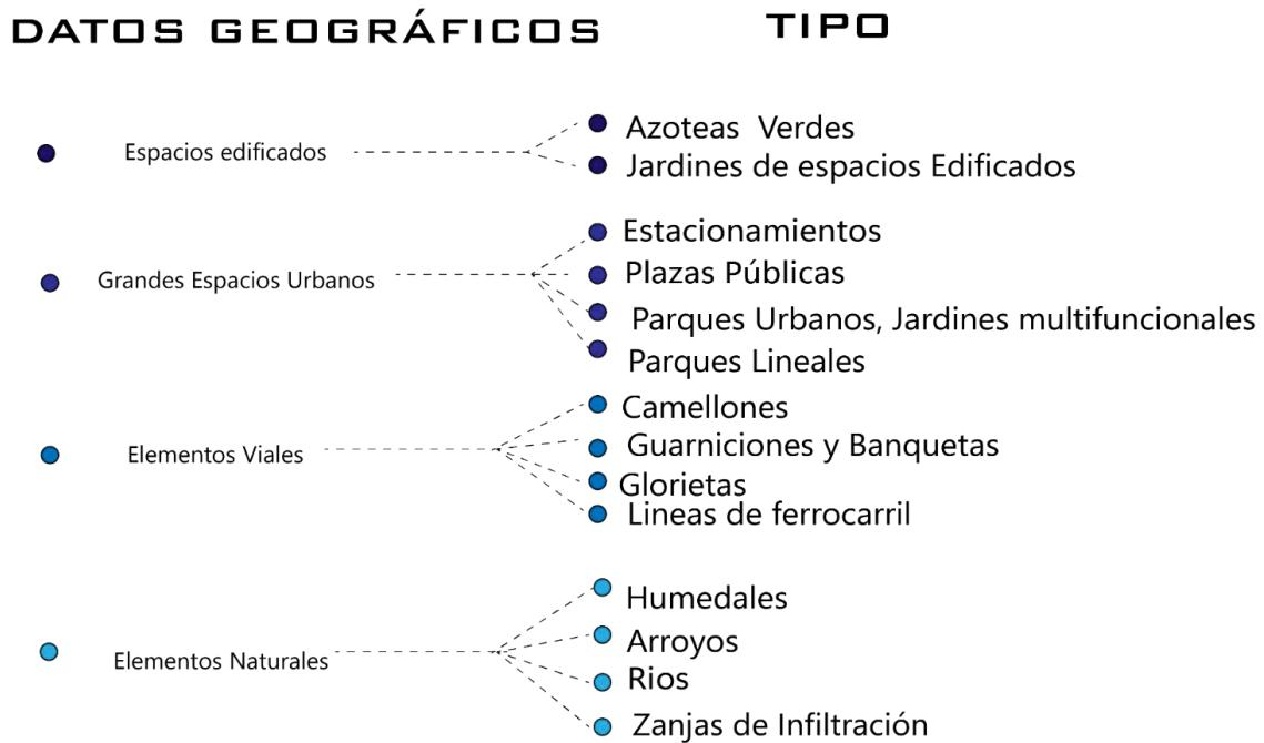
Figura 18 Diagrama clasificación de elementos SUDS por datos geográficos
