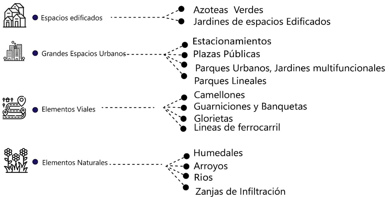
Figura 63 | Diagrama clasificación de elementos SUDS por datos geográficos,
