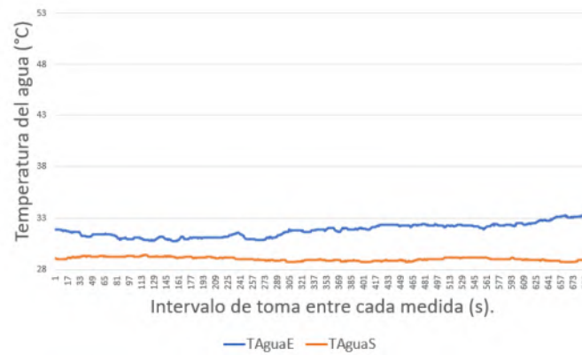
Figura C.13. Datos experimentales registrados a 122.4 RPM de giro de las palas y 3000 RPM el ventilador.
