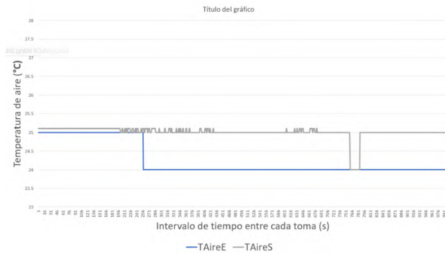
Figura 3.25. Temperaturas del aire a 85 RPM las palas y 3000 RPM el ventilador.
