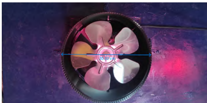
Figura 2.6. Ventilador de la unidad de enfriamiento.
