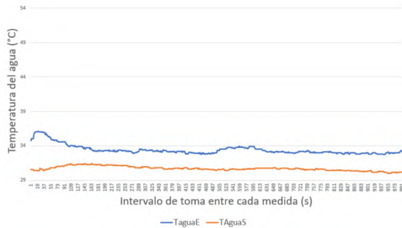
Figura C.7. Datos experimentales registrados a 101.2 RPM de giro de las palas y 3000 RPM el ventilador.
