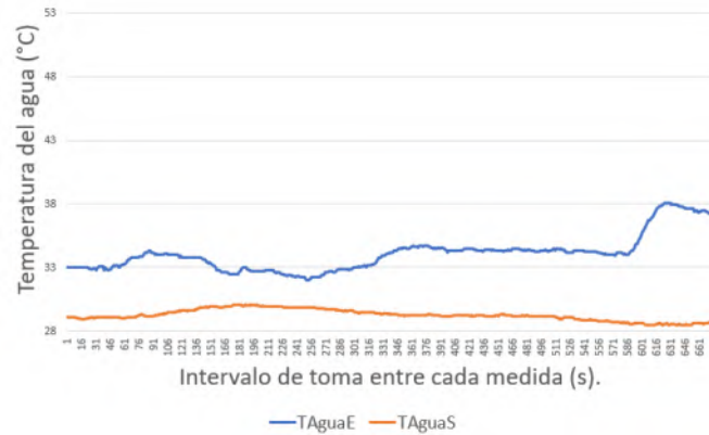
Figura C.14. Datos experimentales registrados a 137.5 RPM de giro de las palas y 3000 RPM el ventilador.
