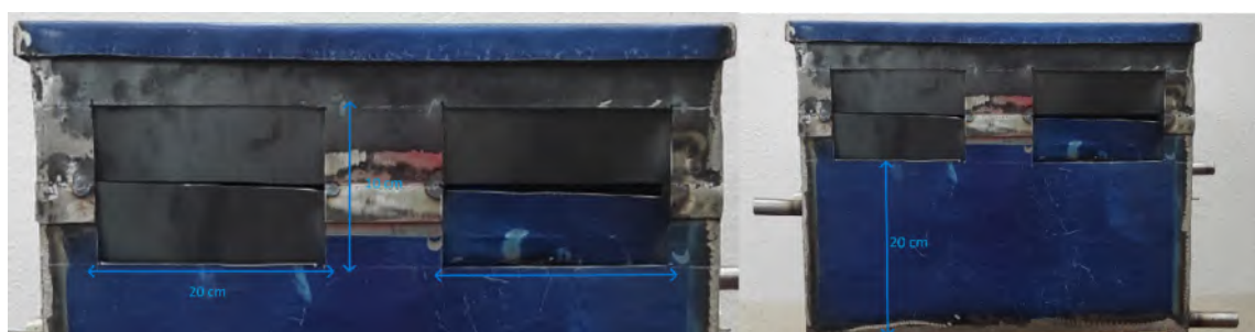
Figura 2.2. Ventanillas de la unidad de enfriamiento y su altura.
