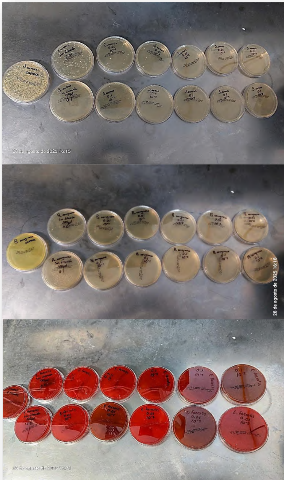
Figura 49 Resultados de inhibición por diluciones de Ti6Al4V tratadas con AgNO 3 por electrodeposición química
