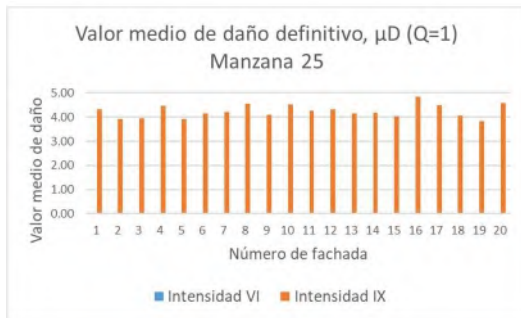
Fig.6.3.25 Valor medio de daño \mu_D con Q=1 (a) y Q=2 (b) de fachadas manzana 25.
