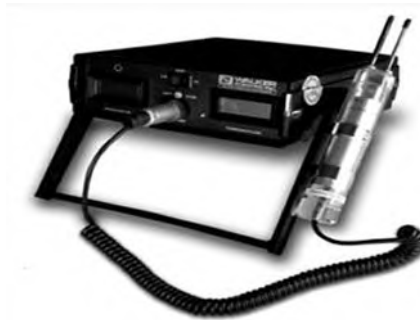
Fig. 3. 16 Equipo de potencial termoeléctrico Thermo-Sorter Walker Scientific.
