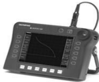
Fig. 3. 19 Equipo Nortec 500D, marca OLYMPUS disponible en el IIMM.
