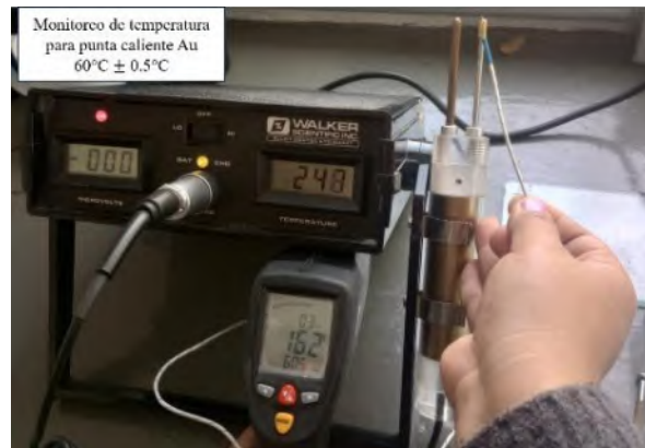
Fig. 3. 18 Monitoreo empleado sobre el control de temperatura para la punta caliente, se observa la temperatura fija para la evaluación por PTE.
